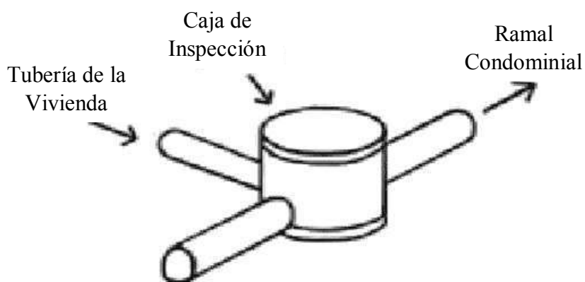
Figura 9. Conexión del ramal dentro del lote
