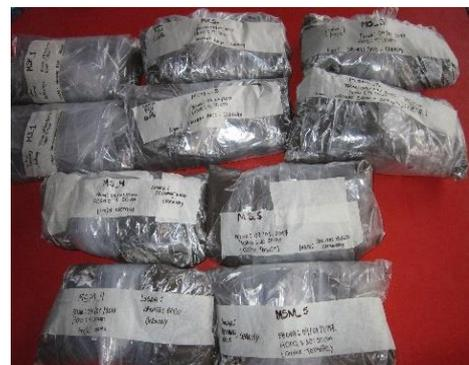
**Fotografía 15: Muestras de suelo selladas para posteriormente ser trasladadas al laboratorio**
