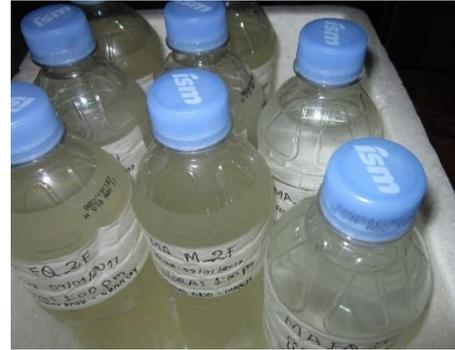
**Fotografía 13: Muestras de agua dentro de la conservadora, refrigeradas y posteriormente ser trasladadas al laboratorio**
