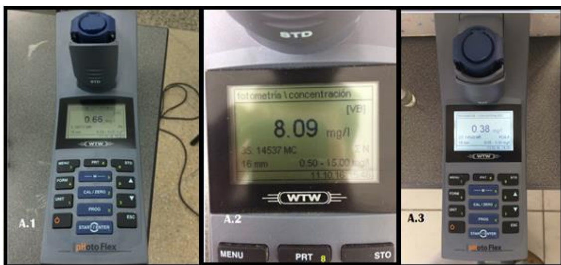
Figura 14. Fotómetro pFotoFlex WTW ®. Se muestran los resultados de parámetros de la muestra de agua tomados del Río. Resultado de Pb (plomo), A.2 resultado de N (Nitrógeno), A.3: resultado de P (Fósforo).
