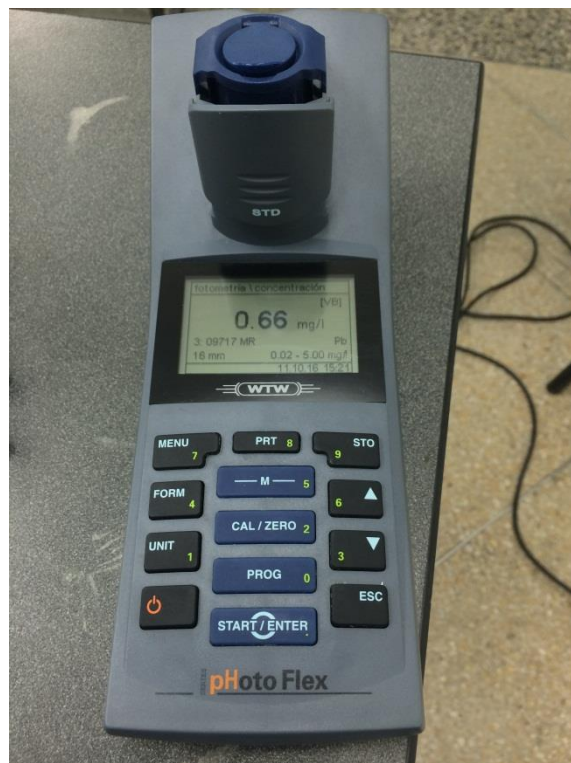
Fotografía 7. Lectura de los parámetros de nitrógeno total, fósforo total y plomo con el equipo Photoflex WTW
