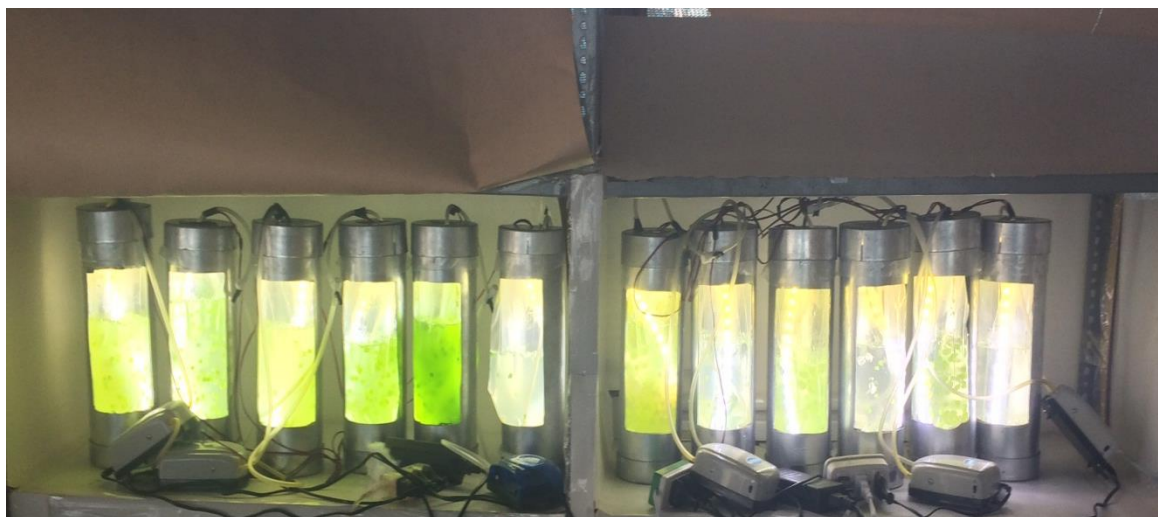
Figura 16. Unidades experimentales. Fotobiorreactores conteniendo células de C. vulgaris en esferas de alginato de sodio.
