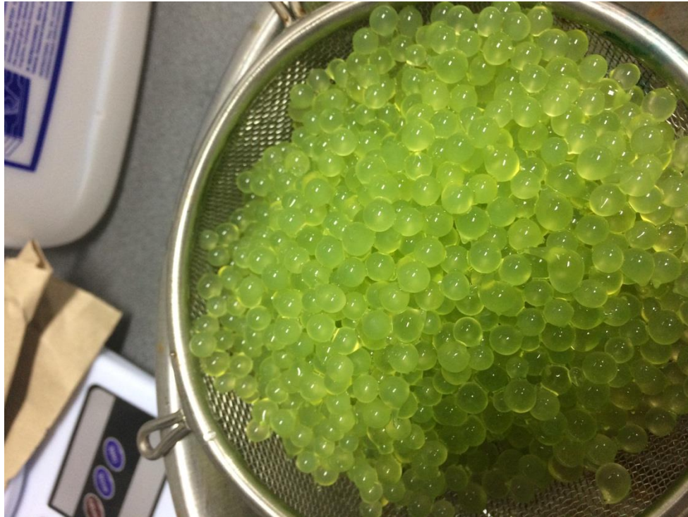
Fotografía 12. Esferas de alginato con las microalgas inmovilizadas.
