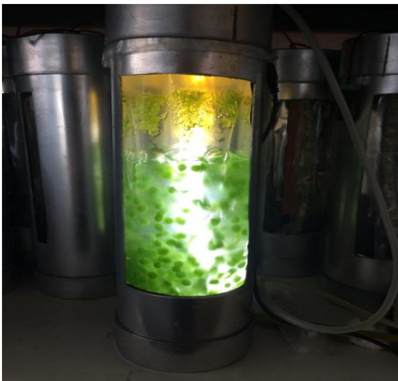
Figura 8. Fotobiorreactor trabajando fase de prueba en la depuración de aguas residuales.
