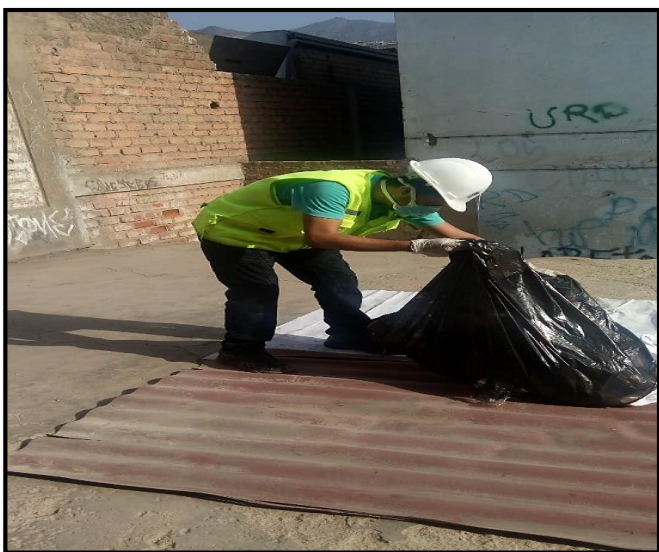
Vertimiento de la muestra para la determinación de la composición física de los RRSS.
