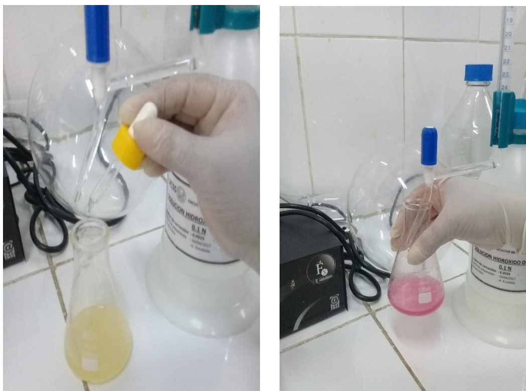
Fotografía 11.4 Análisis de la acidez titulable de la bebida alcohólica
