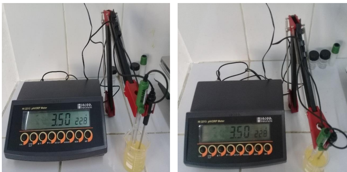
Fotografía 11.2. Análisis del pH de la bebida alcohólica
