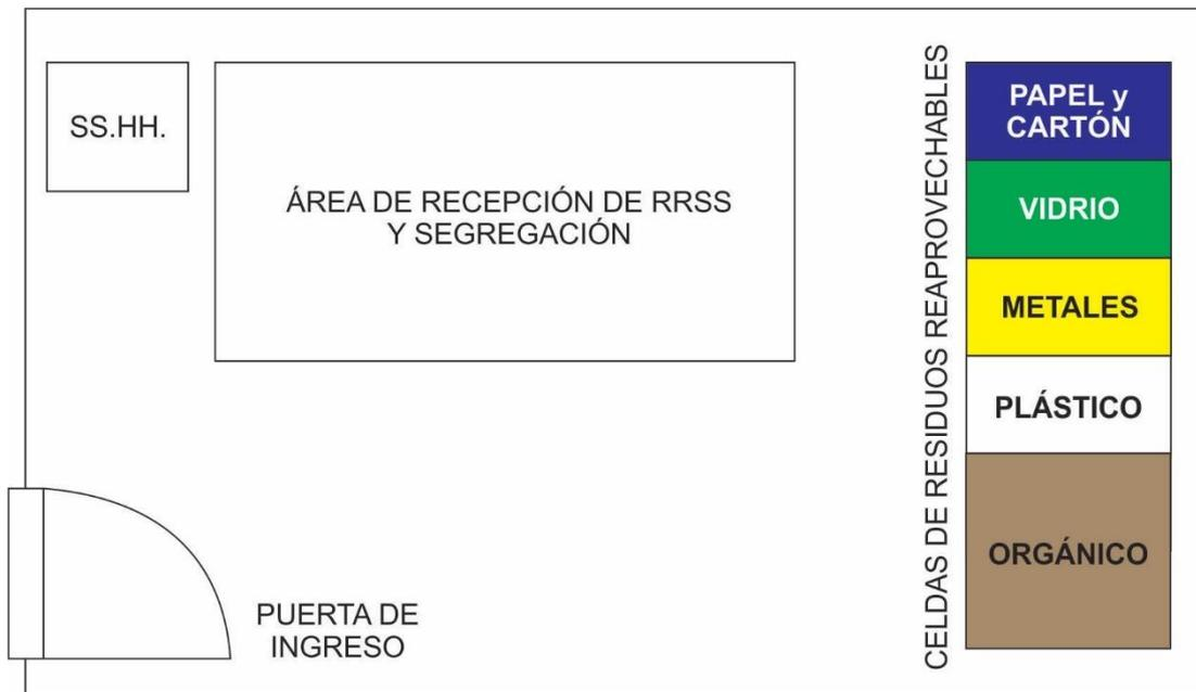
Figura 26. Instalaciones sugeridas para el centro de acopio de residuos sólidos reprovechables
