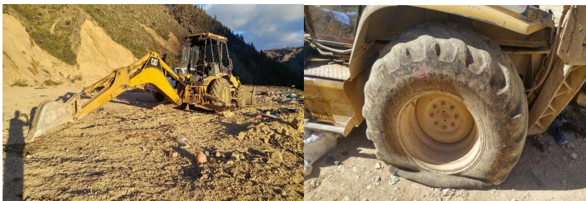
Figura 13. Retroexcavadora del relleno sanitario Pampaya en mal estado de conservación
