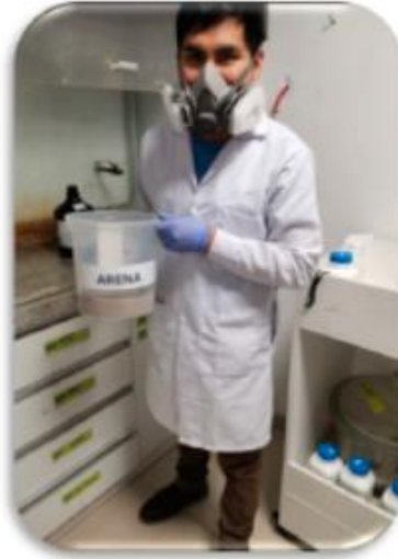
Figura N° 04: Se emplea como material absorbente la arena que está siempre en el área de extracción y digestión de muestras.
