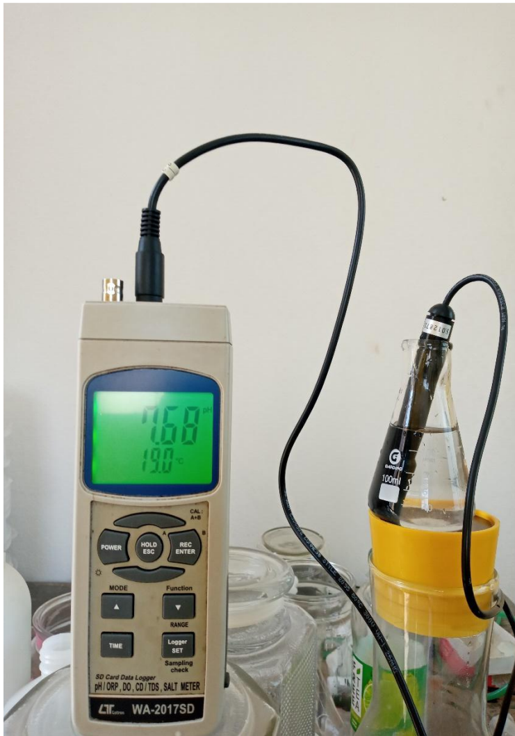
Fotografía 15.2: Medición de parámetros fisicoquímicos (pH)
