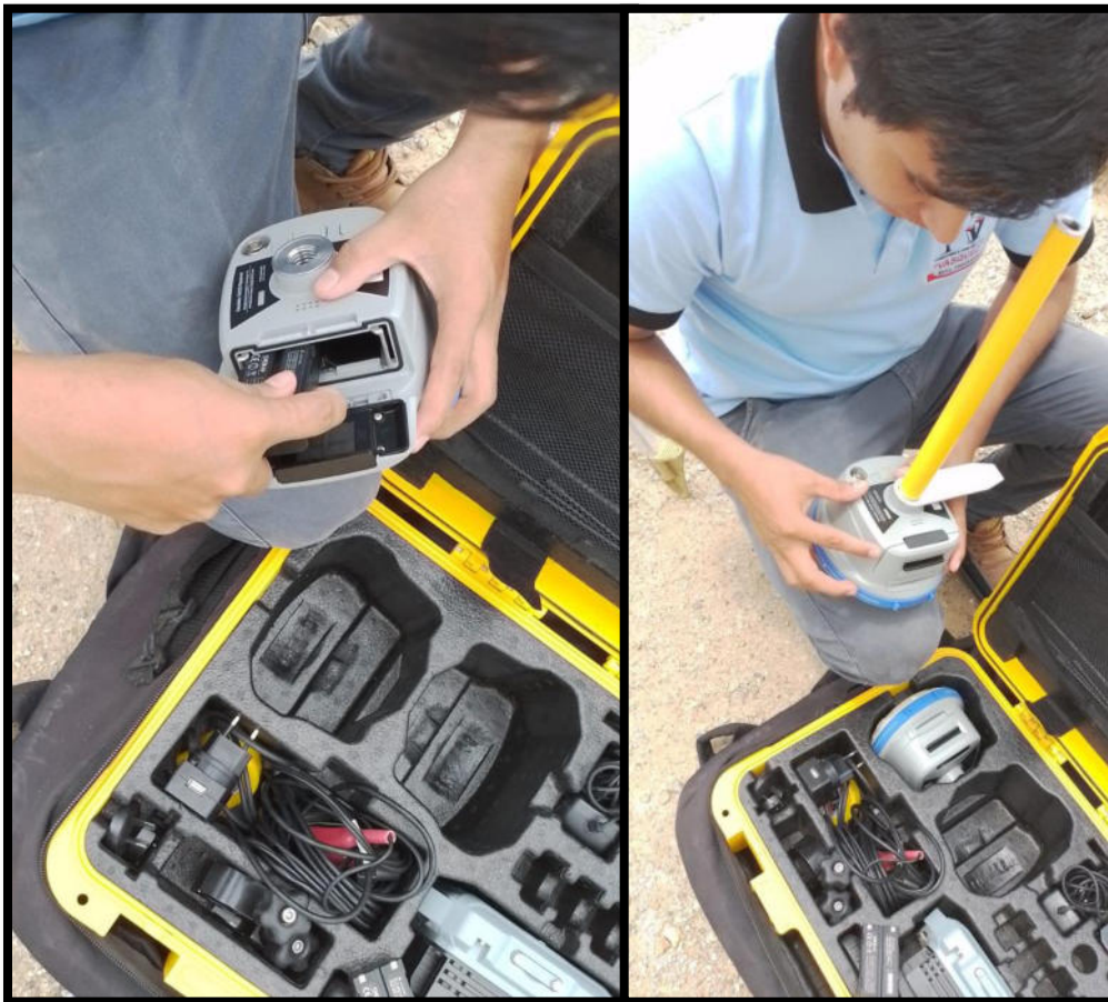
Instalación de Baterías y Tubo de Extensión a la Base Estática
