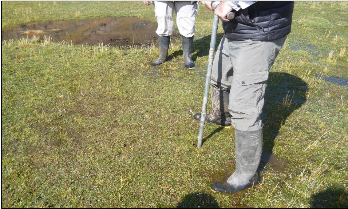
Figura 10. Realización de la perforación con el apoyo del barreno para la instalación de los pozos de monitoreo en el bofedal Piticocha Bajo – RPNYC. Fuente: Elaboración propia.
