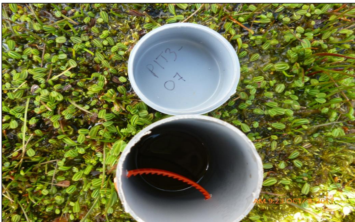
Figura 12. Rotulación de los pozos de monitoreo en el bofedal Piticocha Bajo – RPNYC, para su posterior ubicación y toma de muestras. Fuente: Elaboración propia.
