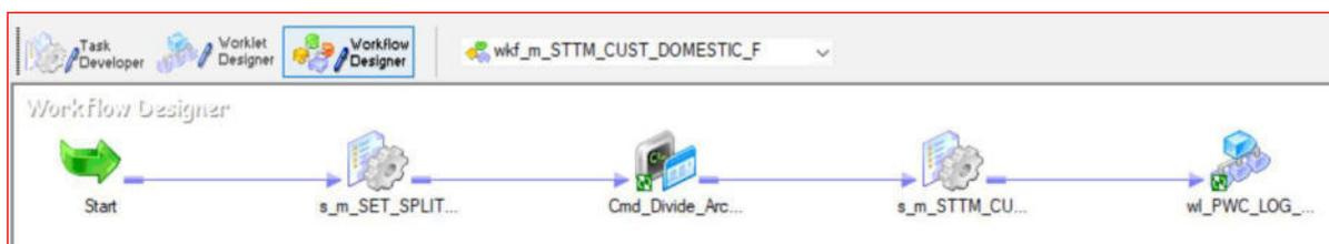
En la figura 17 se muestra el proceso ETL wkf\_m\_STTM\_CUST\_DOMESTIC\_F quien es el encargado de cargar información a la tabla STTM\_CUST\_DOMESTIC, cuya estructura se muestra en el Anexo 7. Este proceso consiste en leer una sábana de datos con información del cliente que posteriormente será ingresada a la tabla STTM\_CUST\_DOMESTIC, pasando por objetos de control para enriquecer los registros y monitorear el proceso de carga.
