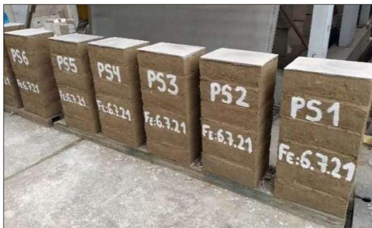
*Nota.* Pilas con el refrentado en la parte superior del espécimen y su respectiva identificación. Archivo fotográfico propio, 2021.
