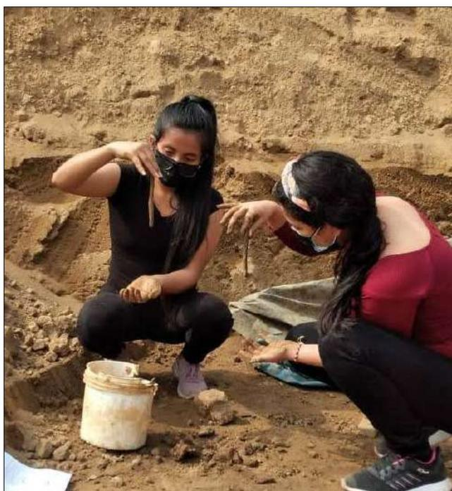
*Nota.* Cintas de 4 mm de espesor estirados hasta una longitud de 14 cm de la prueba in situ cinta de barro. Archivo fotográfico propio, 2021.
