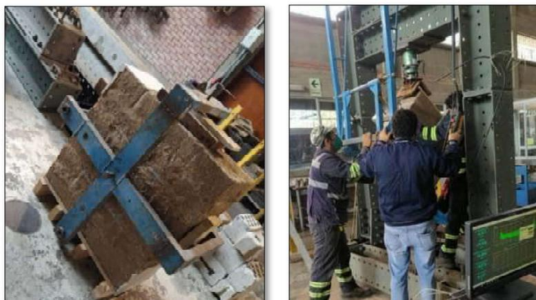
*Nota.* Muretes en sujetadores de carga para el traslado a la máquina de ensayo, de debe trasladar con cuidado para evitar errores por fallas previas al ensayo. Archivo fotográfico propio, 2021.
