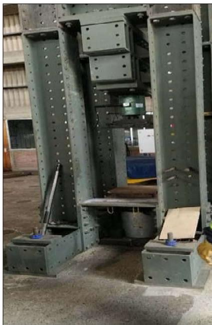
*Nota.* Equipo universal para el ensayo de pilas del Laboratorio de Estructuras Antisísmicas de la PUCP, 2021.
