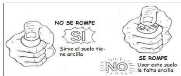
*Nota.* Presión con el pulgar e índice de las manos a la esfera seca. Adaptado de la "Norma E.080 Diseño y Construcción con Tierra Reforzada" (p.28), por el Servicio Nacional de Capacitación para la Industria de la Construcción, 2020.
