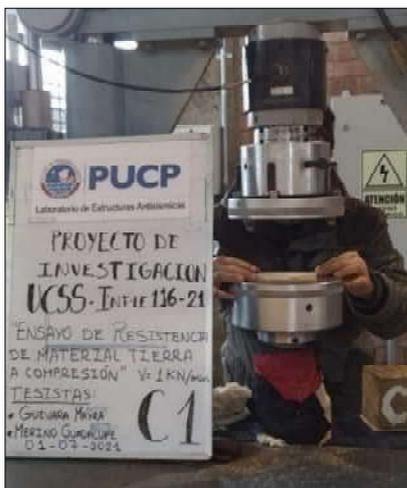
*Nota.* La colocación del triplay debe estar nivelado al centro de la máquina universal.
