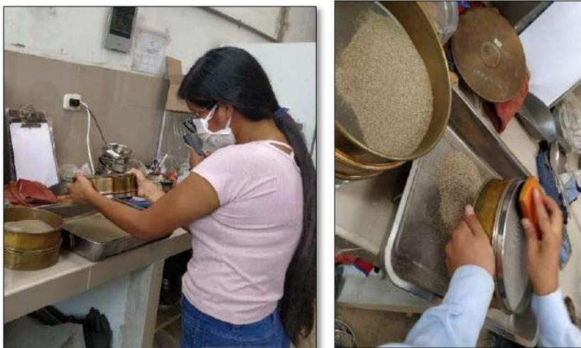
*Nota.* Colocar el material retenido en bandejas y con un cepillo limpiar el material adherido al tamiz. Archivo fotográfico propio, 2021.
