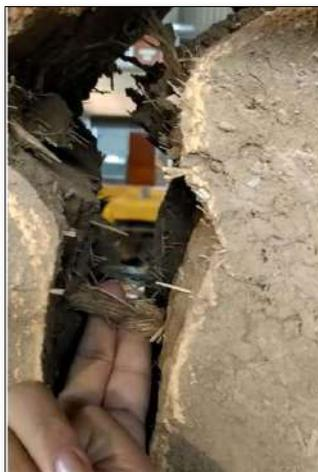
*Nota.* Después de la aplicación de la carga máxima se presencié la mayoría de fibras diagonales intactas. Archivo fotográfico propio, 2021.
