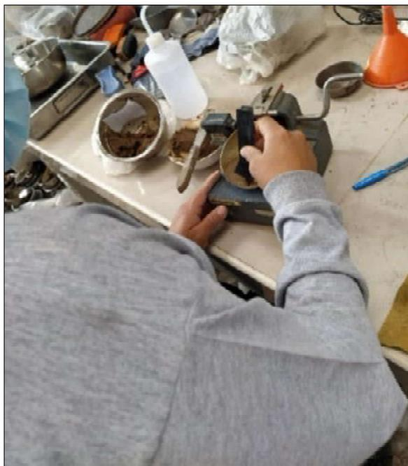
*Nota.* Utilizar un acanalador plástico o metálico para la separación de la mezcla. Copa de Casagrande del Laboratorio Geotécnico MarJent Engineering Lab S.A.C., 2021.
