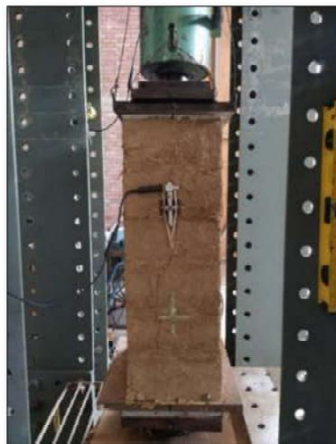
*Nota.* Cada instrumento LVDT local fue sincronizado con la máquina universal de ensayo. Archivo fotográfico propio, 2021.
