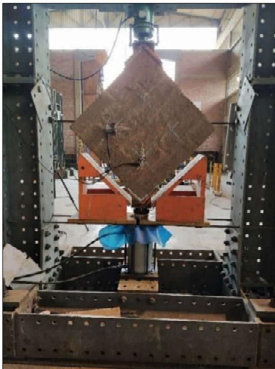
*Nota.* Murete de 77 cm x 77 cm x 25 cm en máquina universal para el ensayo de compresión diagonal del Laboratorio de Estructuras Antisísmicas de la PUCP, 2021.
