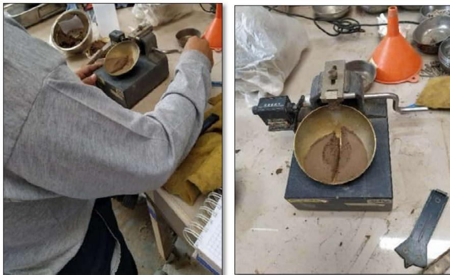
*Nota.* Tener en cuenta la cantidad de agua para el cierre de ranura. Copa de Casagrande del Laboratorio Geotécnico MarJent Engineering Lab S.A.C., 2021.
