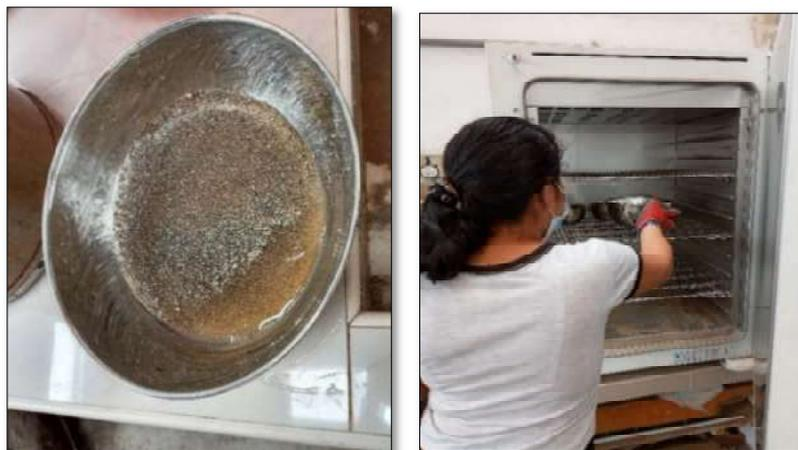
*Nota.* Temperatura constante del horno de laboratorio de 110 °C. Archivo fotográfico propio, 2021.
