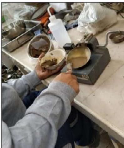
*Nota.* Asegurarse que la mezcla este nivelada con los bordes de la copa de Casagrande. Copa de Casagrande del Laboratorio Geotécnico MarJent Engineering Lab S.A.C., 2021.
