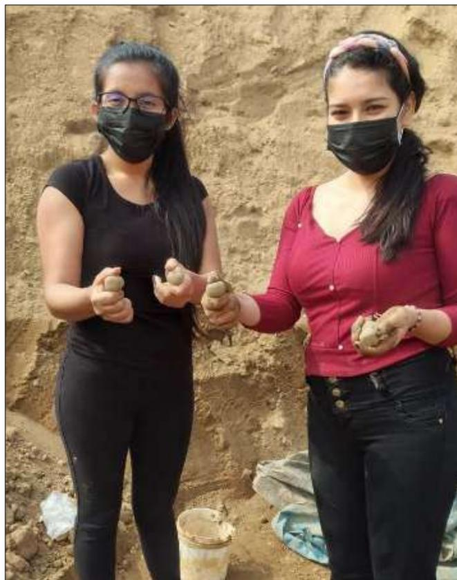
*Nota.* Esferas pequeñas de tierra presionadas con el pulgar e índice para la prueba in situ presencia de arcilla o resistencia seca. Archivo fotográfico propio, 2021.
