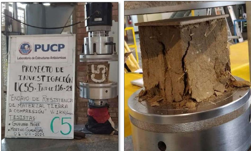
*Nota.* Presencia de fisuras en las esquinas de los especímenes a la aplicación de cargas hasta desintegro de los mismos. Archivo fotográfico propio, 2021.
