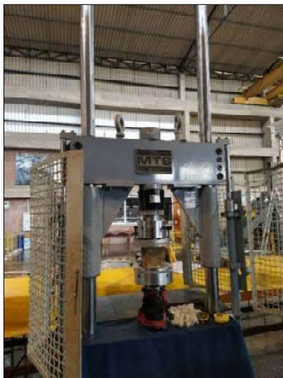
*Nota.* Cubos de 10 cm arista en máquina universal de resistencia a compresión del Laboratorio de Estructuras Antisísmicas de la PUCP, 2021.
