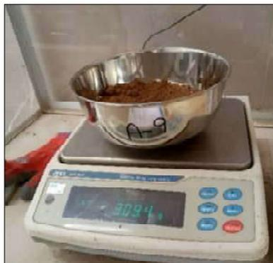
*Nota.* Peso en gramos de la muestra más tara. Tara y balanza del Laboratorio Geotécnico MarJent Engineering Lab S.A.C., 2021.
