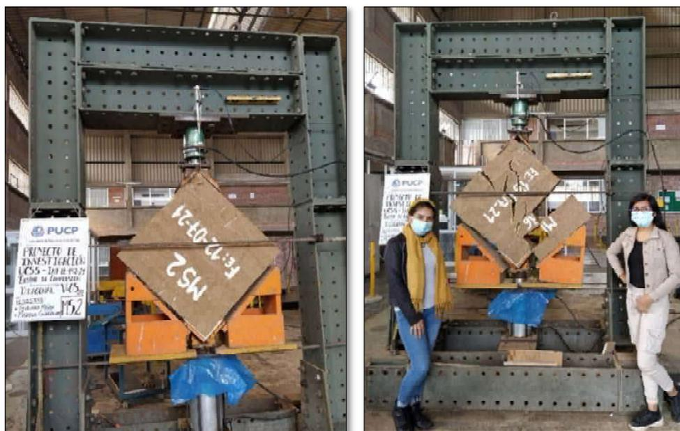
*Nota.* Carga aplicada a especímenes de muretes de bloques de adobe con presencia de falla mixta, por tracción diagonal y escalonada en juntas de mortero. Archivo fotográfico propio, 2021.
