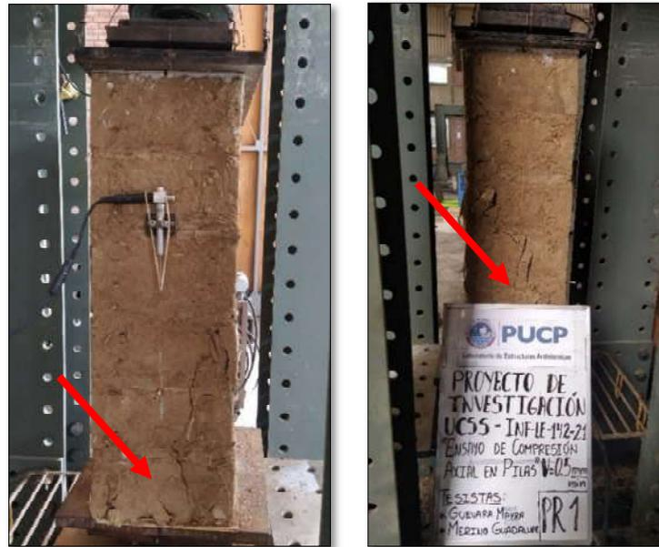
*Nota.* El aplastamiento local se observa a mayor detalle en la parte inferior de la pila. Archivo fotográfico propio, 2021.
