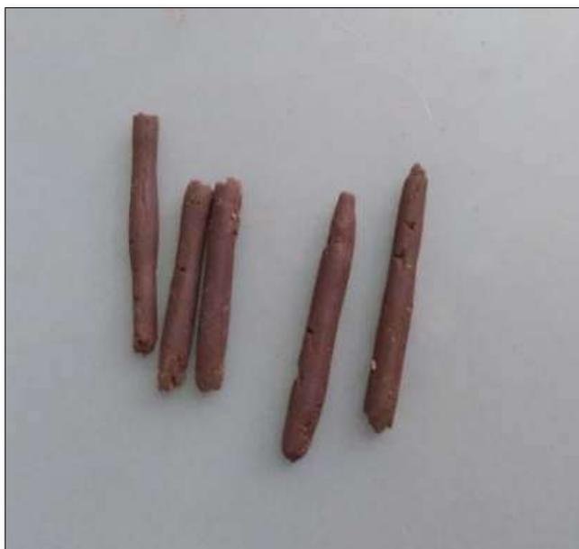
*Nota.* Cilindros formados con un diámetro de 3,2 mm. Archivo fotográfico propio, 2021.
