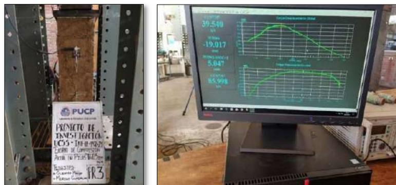
*Nota.* En el monitor se observó la máxima carga, las gráficas de carga versus desplazamiento. Archivo fotográfico propio, 2021.
