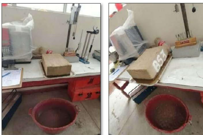
*Nota.* Se utilizó una botella con agua para mantener el nivel de agua constante de la bandeja y una tina para la caída del agua manteniendo la zona del ensayo limpia. Archivo fotográfico propio, 2021.
