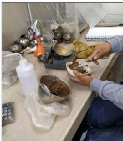
*Nota.* Tener una buena consistencia de la mezcla. Copa de Casagrande del Laboratorio Geotécnico MarJent Engineering Lab S.A.C., 2021.
