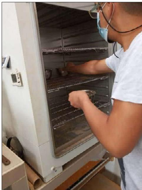
*Nota.* El horno de laboratorio debe estar a una temperatura constante de 110 °C. Horno del Laboratorio Geotécnico MarJent Engineering Lab S.A.C., 2021.
