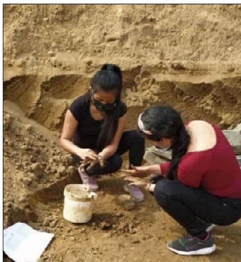
*Nota.* Formación de cilindros de 12 mm de diámetro de la prueba in situ cinta de barro. Archivo fotográfico propio, 2021.
