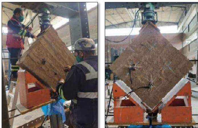
*Nota.* Instrumentos LVDT vertical y horizontal con conexión a software para lectura de desplazamientos. Archivo fotográfico propio, 2021.
