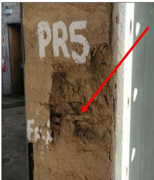
*Nota.* Lo señalado con la flecha de color rojo son los refuerzos de fibras diagonales de Arundo Donax en los bloques de adobe después del ensayo. Archivo fotográfico propio, 2021.
