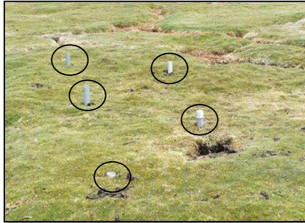
Figura 10. Tubos PVC de dos pulgadas insertadas en cada punto de muestreo. Fuente: Elaboración propia.
