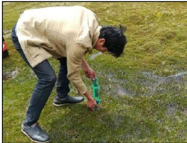
Figura 14. Reinstalación de las muestras secas a cada punto de muestreo. Fuente: Elaboración propia.
