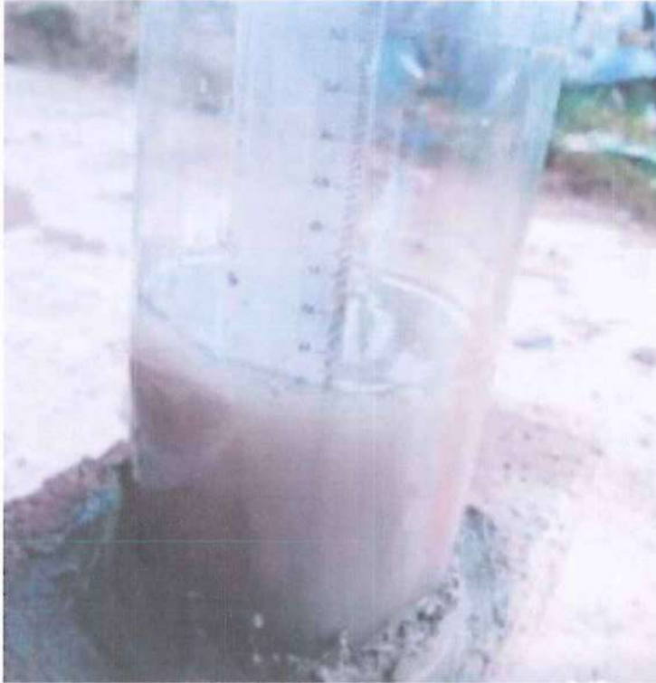
Imagen 30. Medición en base a que tiempo demora en absorber el bloque de concreto con 4% de Aloe Vera un cm de agua.
