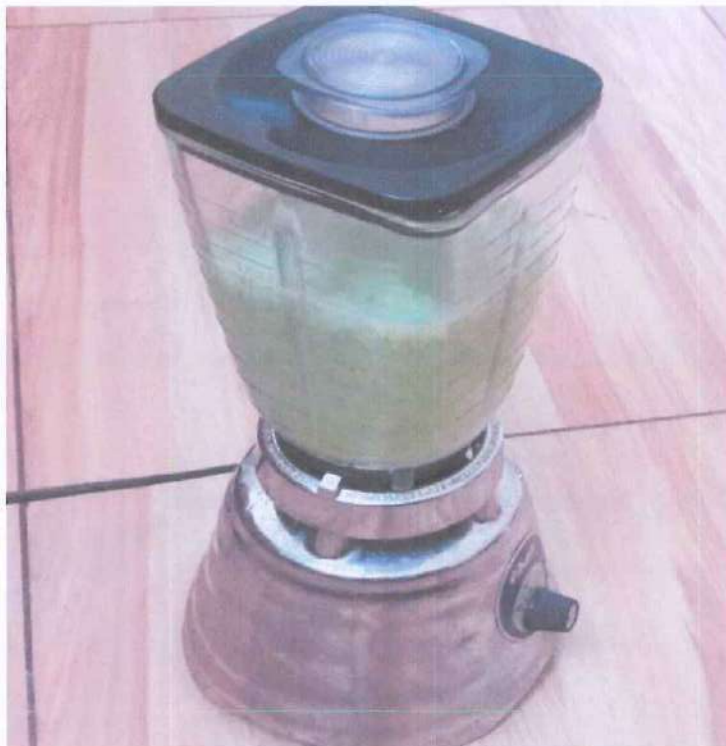
Imagen 12. Licuado del Aloe Vera para su posterior adición al agregado.
