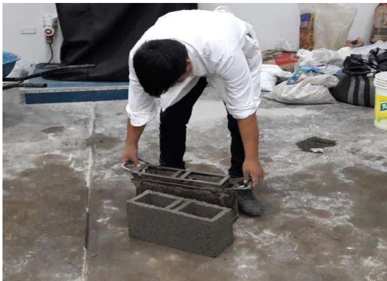
Figura 30. Testigos de bloques de concreto. Fuente: Elaboración propia.
