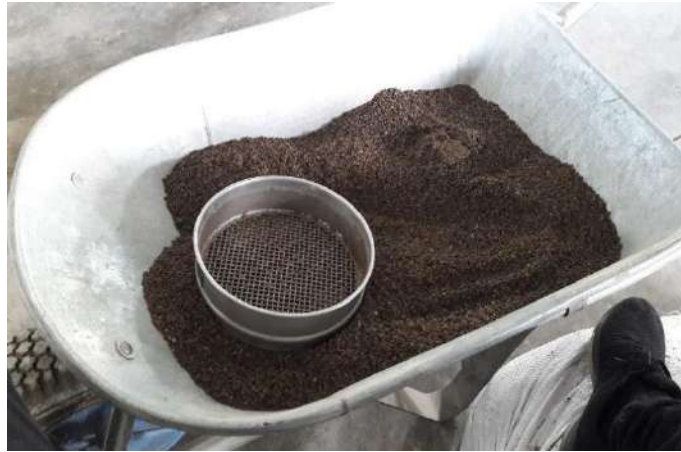
Figura 24. Zarandeado de la arena en la malla N° 4 Fuente: Elaboración propia.
