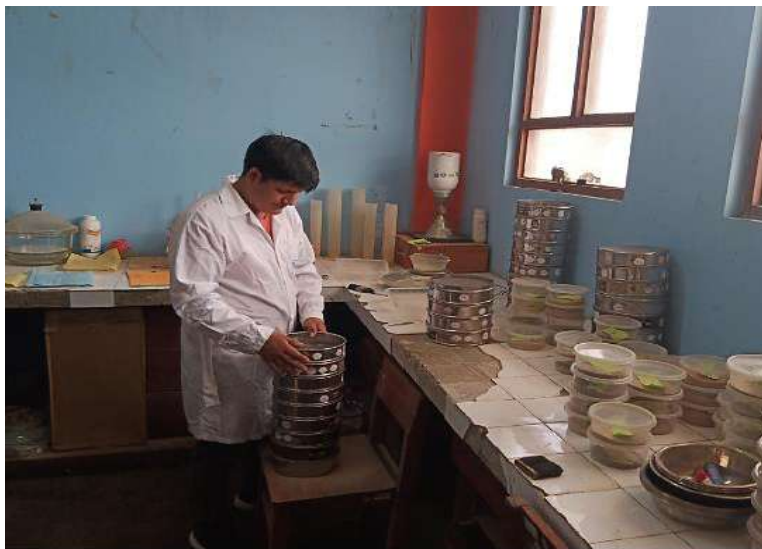
Figura 11. Ensayo de granulometría de la arena. Fuente: Elaboración propia
