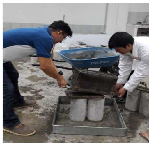
Figura 29. Golpeado en tres capas el bloque. Fuente: Elaboración propia.
