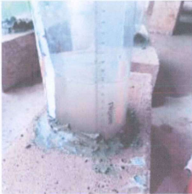
Imagen 32. Medición en base a que tiempo demora en absorber el bloque de concreto con 6% de Aloe Vera un cm de agua.
