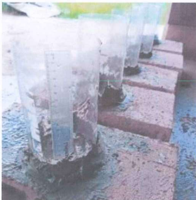
Imagen 23. Colocación y sellado al bloque con las probetas
