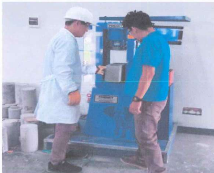
Imagen 35. Se observa la verificación de roturas de los bloques de concreto prototipo realizado por el tesista según la Norma Peruana - NTP – 399.613 y 339.604.
