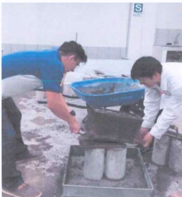
Imagen 14. Moldeamiento de los bloques de concreto.
