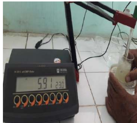
Figura 20. Ensayo de sales solubles del Aloe Vera. Fuente: Elaboración propia
