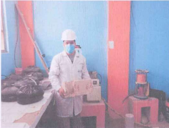
Imagen 6. Se observa los testigos de bloques de concreto con aditivo adicionado al 6% para su rotura correspondiente
