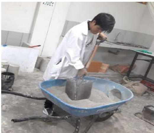
Figura 26. Homogenización de los agregados Fuente: Elaboración propia.
