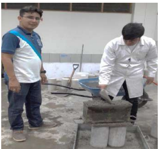
Figura 28. Colocación del agregado al molde. Fuente: Elaboración propia.
