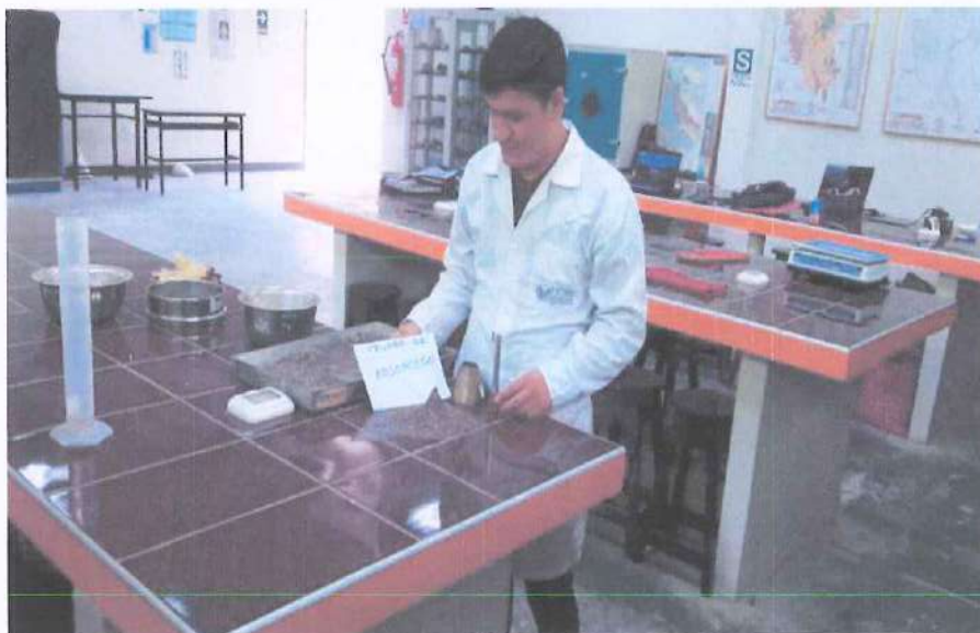
Imagen 4. Se visualiza al tesista realizando el ensayo de absorción de la arena.
