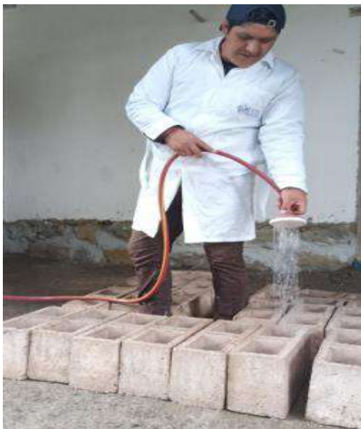
Figura 32. Curado de bloques de concreto por el método de aspersión. Fuente: Elaboración propia.
