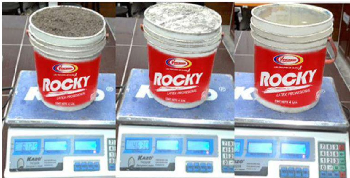
Figura 25. Pesado de agregados que fueron utilizados para los bloques de concreto. Fuente: Elaboración propia.
