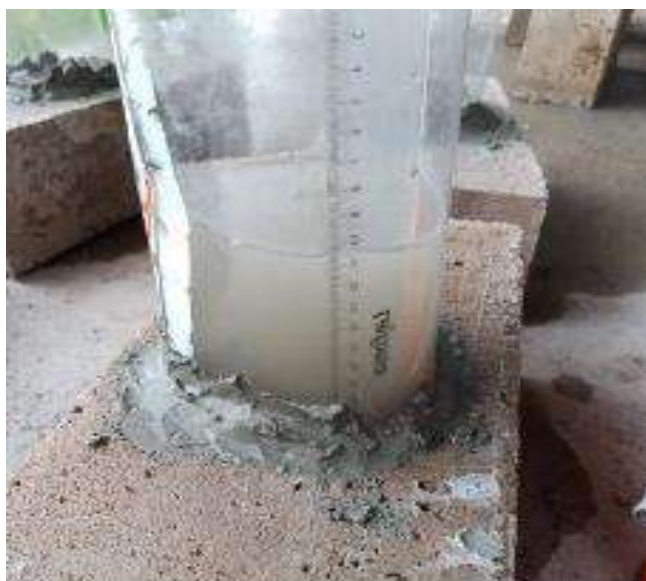
Figura 35 . Infiltración del agua en bloques de concreto con y sin adición de Aloe Vera Fuente: Elaboración propia.
