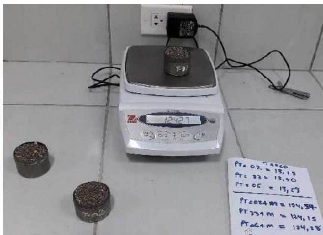
Figura 13. Ensayo de humedad natural de la arena Fuente: Elaboración propia
