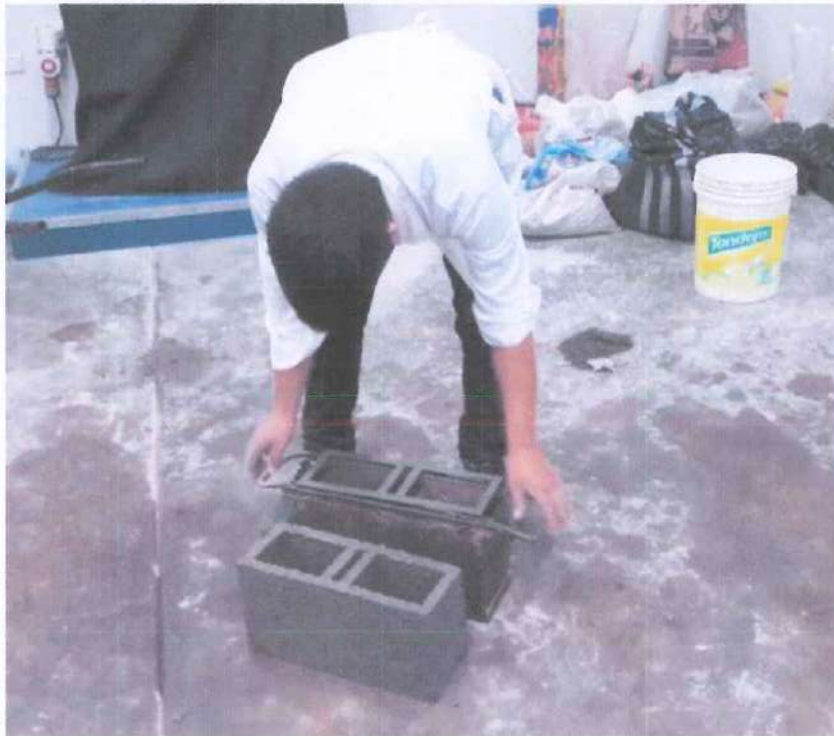
Imagen 15. La imagen muestra el desmoldeamiento del bloque de concreto.
