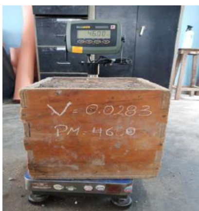
Figura 9. Peso unitario suelto de la arena.
