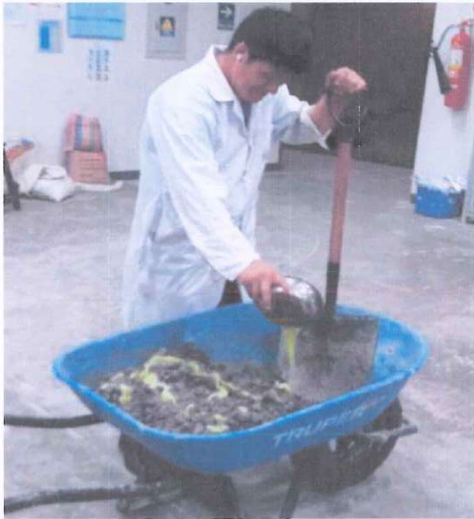
Imagen 13. Adición del Aloe Vera en la mezcla según el porcentaje de diseño.
