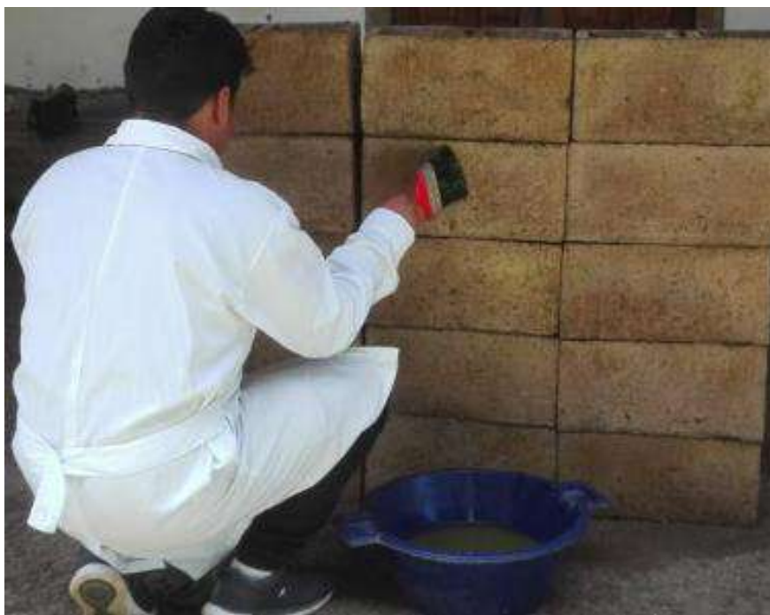
Figura 34. Aplicación directa del aditivo natural de Aloe Vera a los bloques de concreto. Fuente: Elaboración propia.
