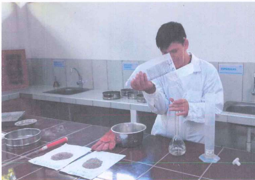
Imagen 6. Se observa al tesista en la realización del ensayo de peso específico –método fiola.
