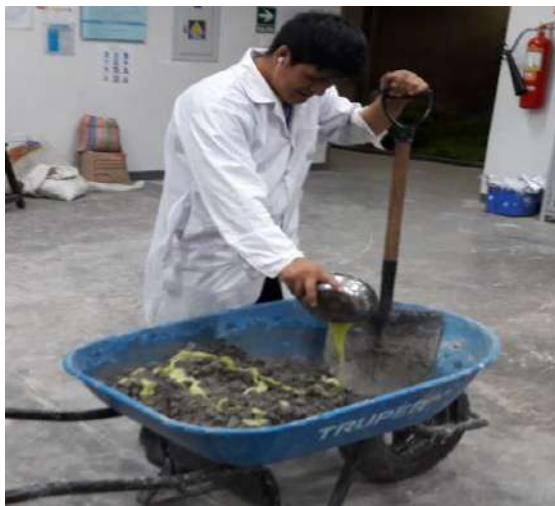
Figura 33. Combinación del Aloe Vera con los agregados. Fuente: Elaboración propia.
