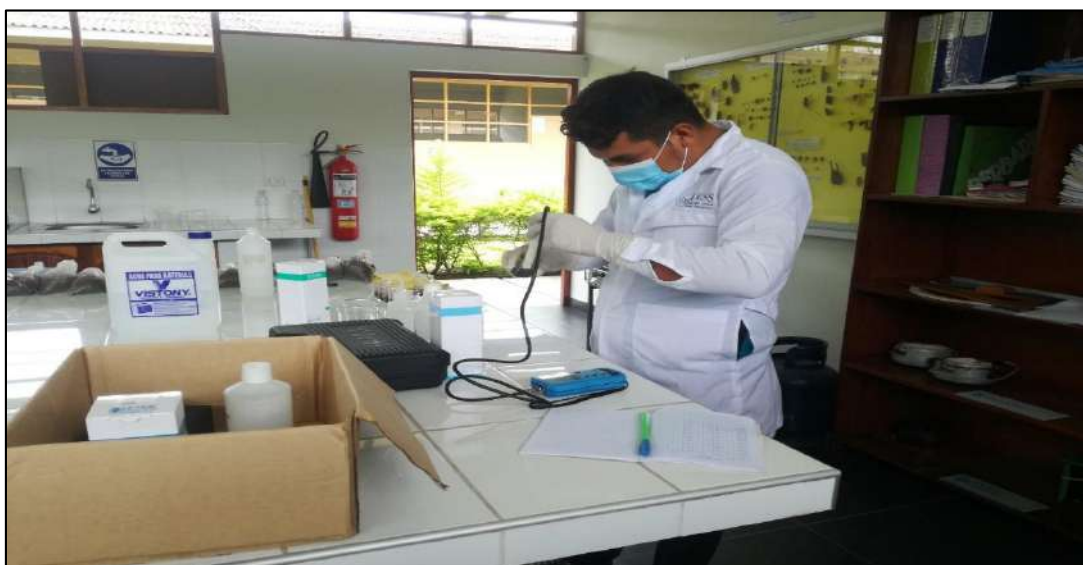
Figura 20. Medición de pH con el multiparámetro HI9811-5. Fuente: Elaboración propia.
