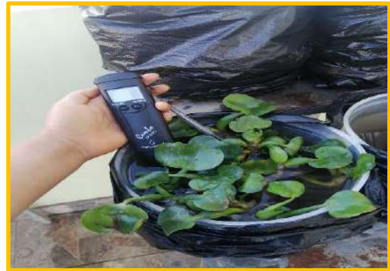
12. Evaluación de la conductividad eléctrica de la solución agua-efluente cianurado
