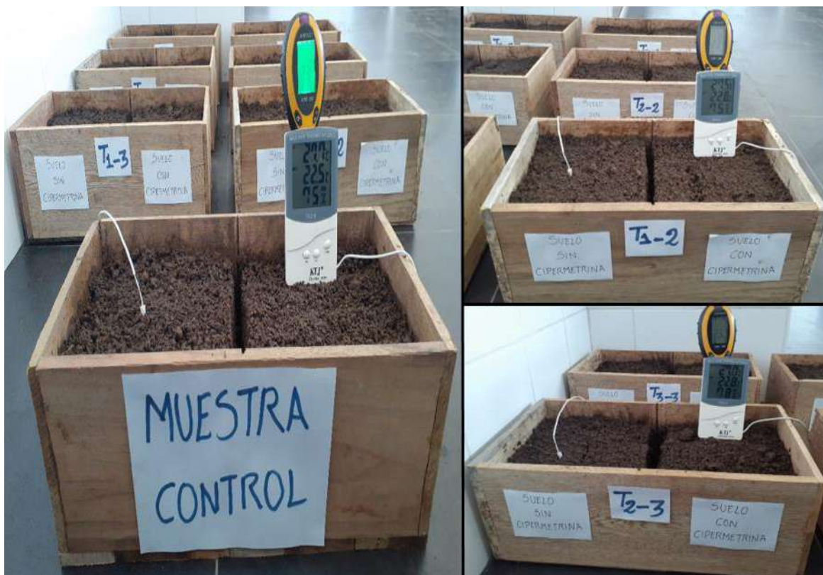
Figura 25. Medición de humedad y temperatura. Fuente: Elaboración propia.
