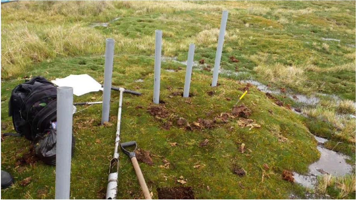
Imagen 10. Instalación de los tubos de 2 pulgadas en las áreas de donde se extrajeron las muestras. Fuente: elaboración propia.
