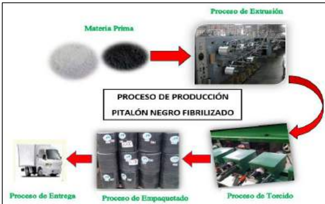
Figura 20. Proceso de producción - pitalón negro fibrilizado
