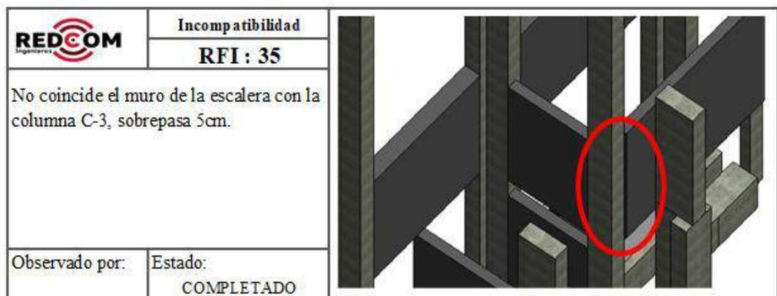
Figura 22. Dibujo del muro que sobrepasa en 5cm a columna.
