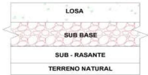
Figura 3. Sección de pavimento rígido
