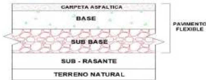
Figura 2. Sección de pavimento flexible
