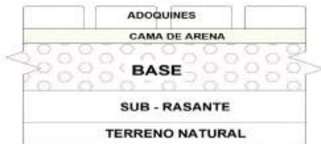
Figura 4. Sección de pavimento articulado.
