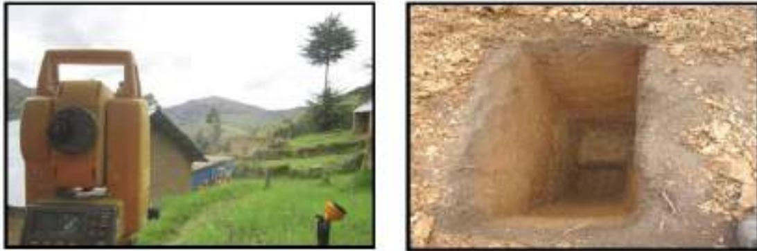
Figura 1. Levantamiento topográfico en terreno accidentado y ondulado (izquierda) y calicata N° 54 - arcilla inorgánica de mediana plasticidad de color marrón (derecha).
