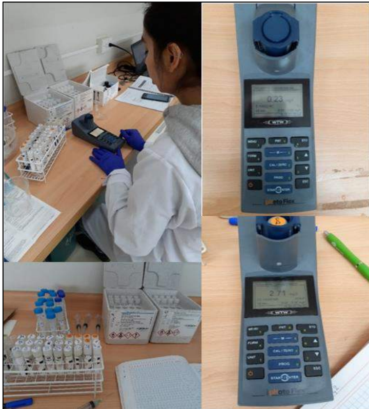
Figura 14. Proceso de determinación de Cromo Total, nitrógeno, fósforo y plomo. Fuente: Elaboración propia.
