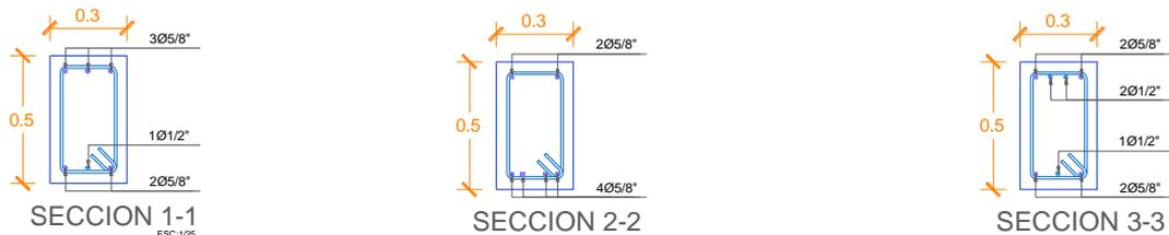
Figura 38 Aceros Propuestos en el Plano, para las Vigas Principales del eje F-F
