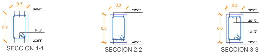
Figura 35 Aceros Propuestos en el Plano, para las Vigas Principales del eje C-C
