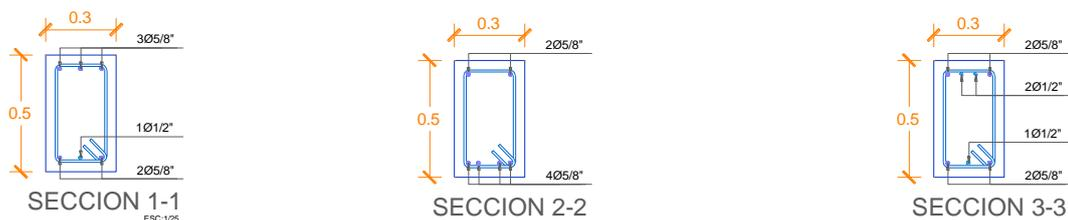
Figura 34 Aceros Propuestos en el Plano, para la Viga Principal del eje B-B
