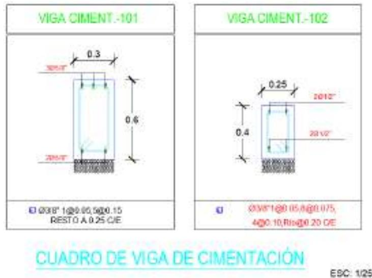
Figura 9 Cuadro de Viga de Cimentación (VC) (propuesto – replanteado – realizado)
