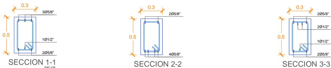
Figura 37 Aceros Propuestos en el Plano, para las Vigas Principales del eje E-E
