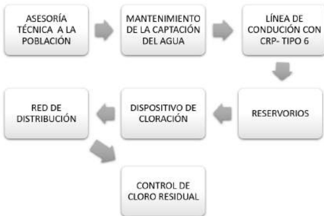
Diagrama 1. Mantenimiento general del sistema de abastecimiento de agua Fuente: Elaboración Propia
