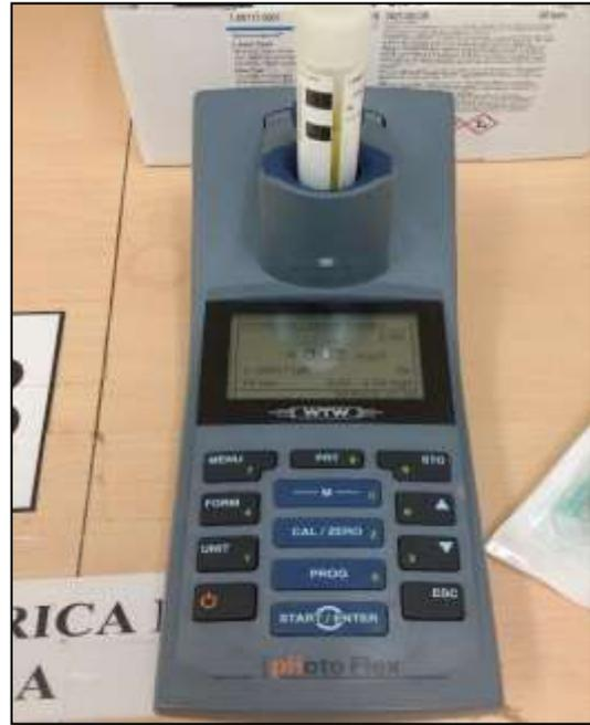
Calibración del fotómetro para la lectura del contenido de plomo
