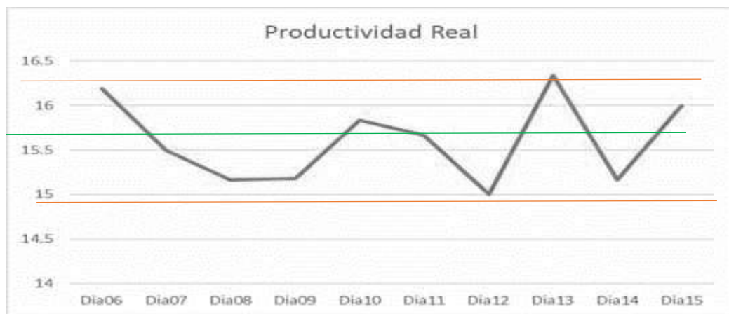
Figura 74. Representación de la productividad de excavación a nivel de subrasante.
