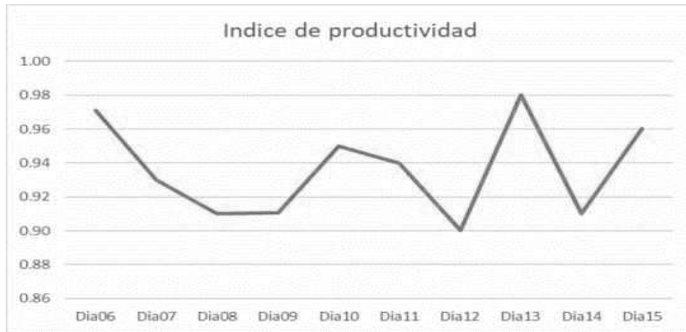
Figure 28. Representación de índice diario de demolición pavimento flexible.
