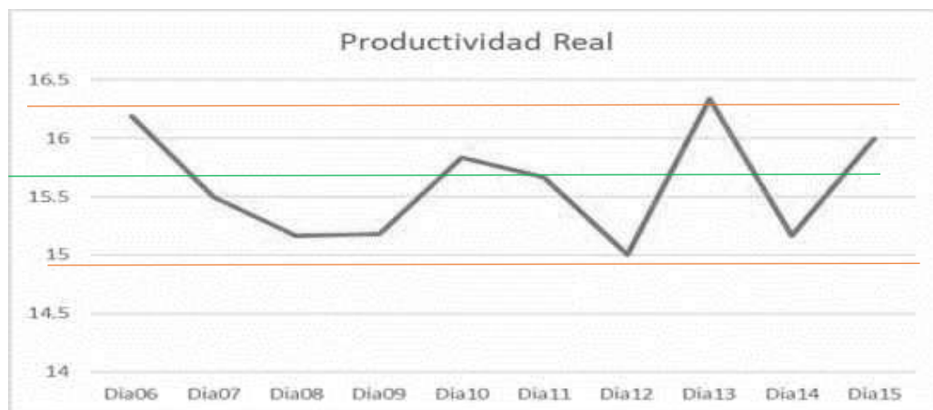
Figura 106. Representación de la varianza de la productividad de compactación de subbase.
