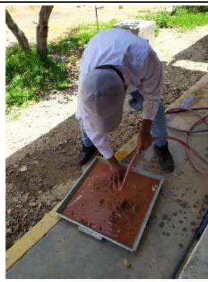
Lavado de la muestra para los respectivos ensayos d Mecánica de Suelos.
