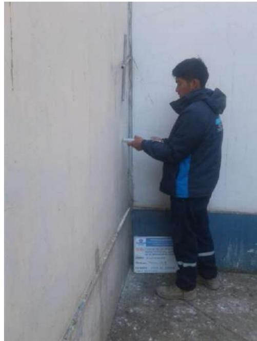
Ensayo de golpes en la placa de ascensor.
