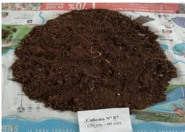
Fotografía 5: Secado de la muestra de la capa de 20 – 60 cm
