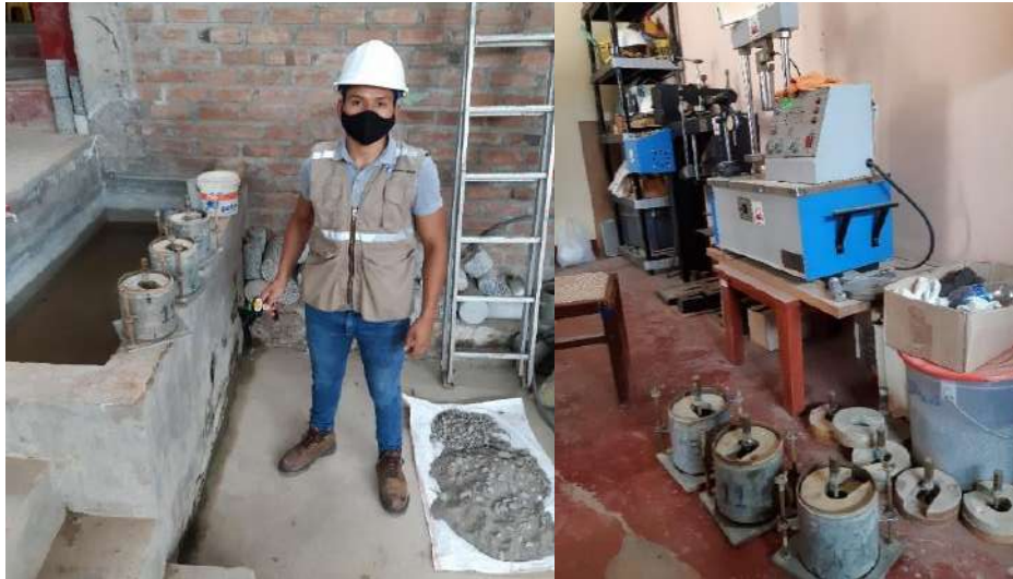
Figura 54. Ensayo 2 cbr 60% afirmado y 40% ladrillo pulverizado.
