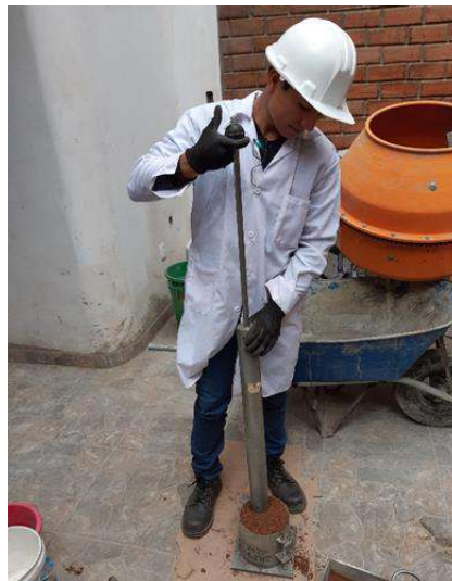
Figura 15. Procedimiento del ensayo proctor modificado.
