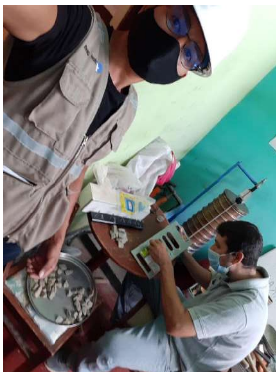
Figura 34. Ensayo de partículas chatas y alargadas (afirmado).
