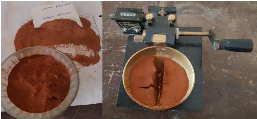
Figura 40. Ensayo límites de consistencia (ladrillo pulverizado).
