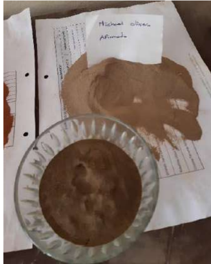
Figura 32. Ensayo límites de consistencia (afirmado).
