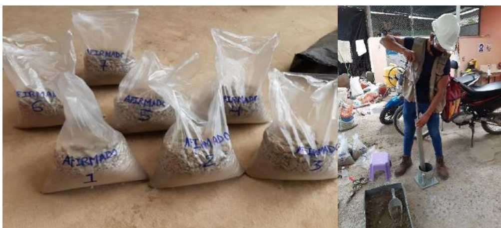
Figura 36. Ensayo proctor modificado del material afirmado.
