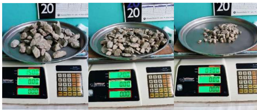
Figura 35. Ensayo caras fracturadas (afirmado).
