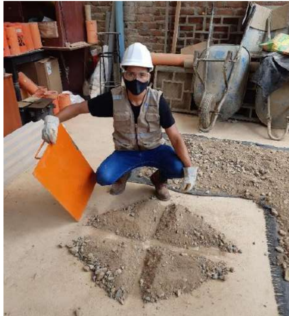
Figura 31. Ensayo granulometría y límites de consistencia.
