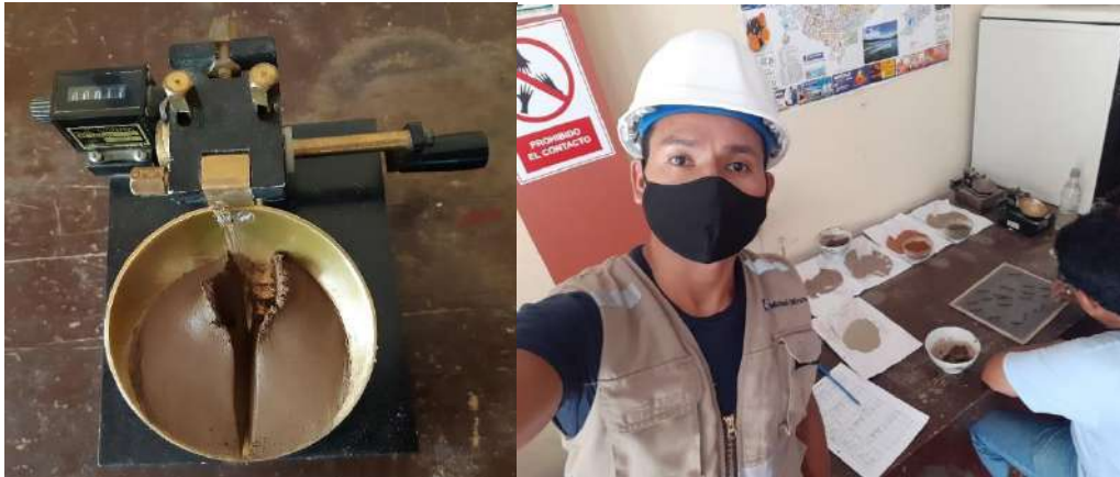
Figura 26. Ensayo limite líquido y limite plástico del suelo natural.
