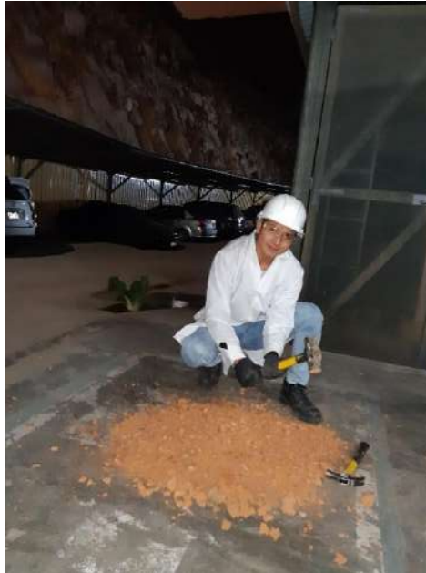
Figura 9. Trituración de ladrillos de arcilla desechados de la construcción.
