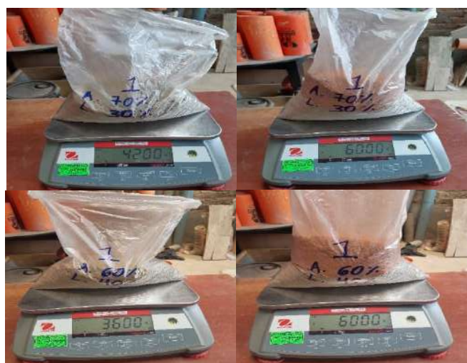
Figura 45. Mezcla %afirmado y %ladrillo para ensayo proctor modificado y cbr.
