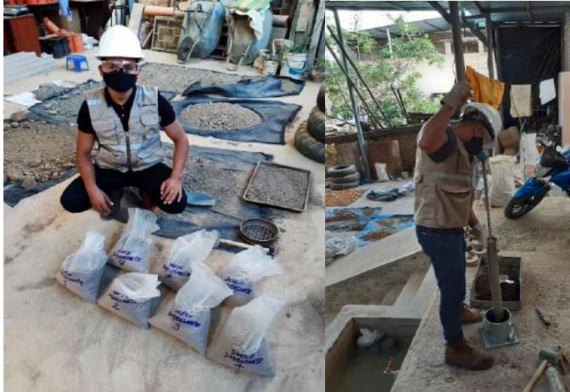
Figura 29. Ensayo proctor modificado de la sub rasante - suelo natural.
