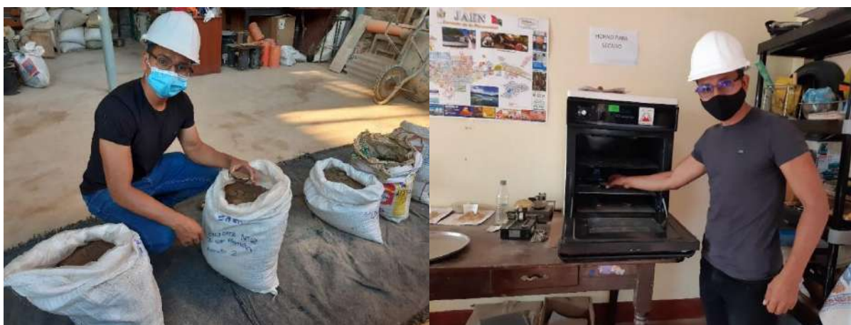
Figura 24. Ensayo contenido de humedad del suelo natural y afirmado.
