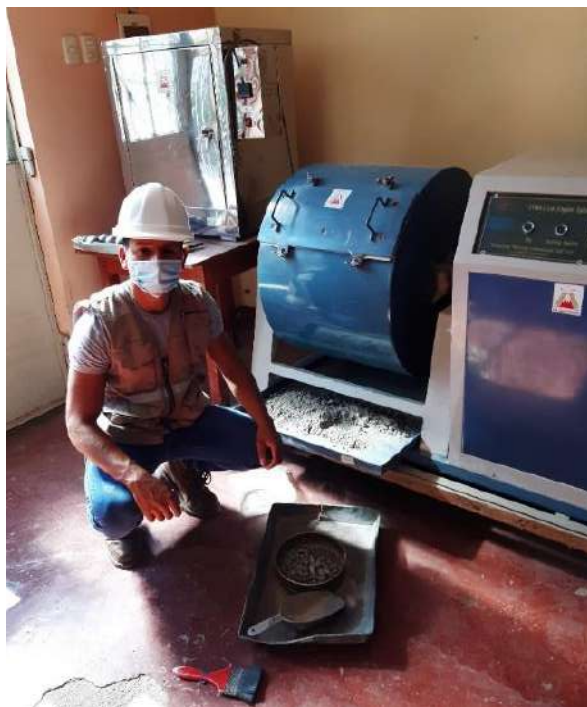
Figura 52. Ensayo abrasión los ángeles 60% afirmado y 40% ladrillo.
