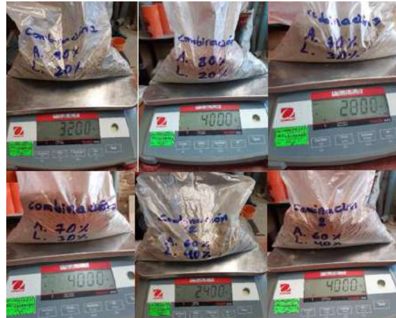
Figura 41. Muestras (afirmado - ladrillo pulverizado) granulometría.
