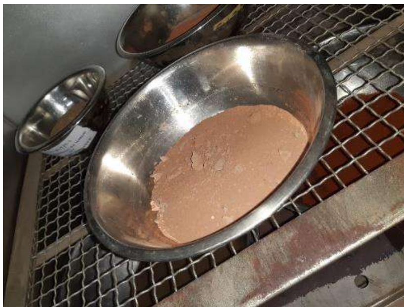
Figura 13. Ensayo de contenido de humedad – mezcla afirmado y ladrillo pulverizado.
