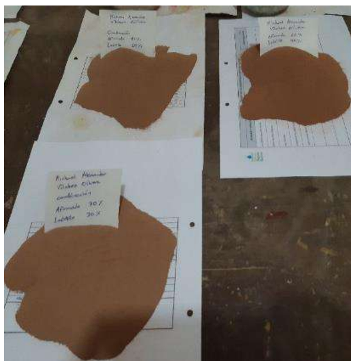
Figura 44. Mezcla de afirmado y ladrillo pulverizado para límites de consistencia.
