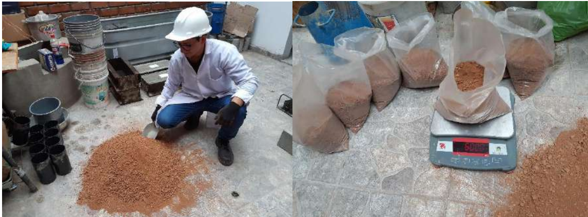
Figura 14. Preparación muestras para ensayo proctor modificado y cbr
