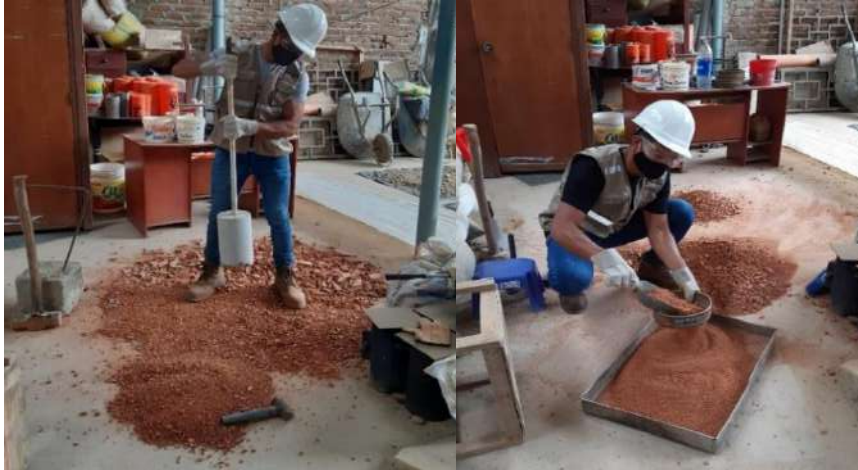
Figura 38. Pulverizado de bloques de ladrillo de arcilla.
