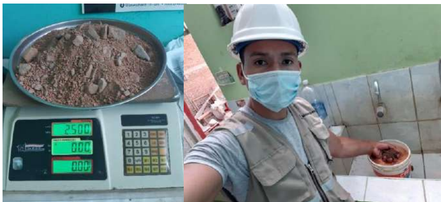
Figura 51. Ensayo material que pasa malla N°200 60% afirmado y 40% ladrillo.
