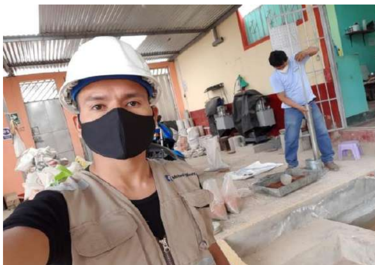
Figura 47. Ensayo proctor modificado 70% afirmado y 30% ladrillo pulverizado.
