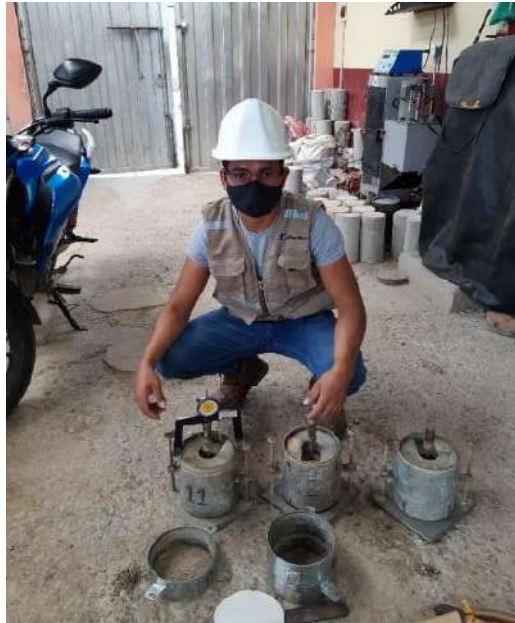
Figura 37. Ensayo cbr del material afirmado.
