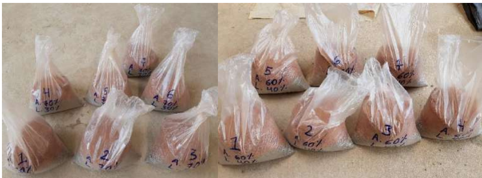
Figura 46. Muestras %afirmado y %ladrillo para ensayo proctor modificado y cbr.
