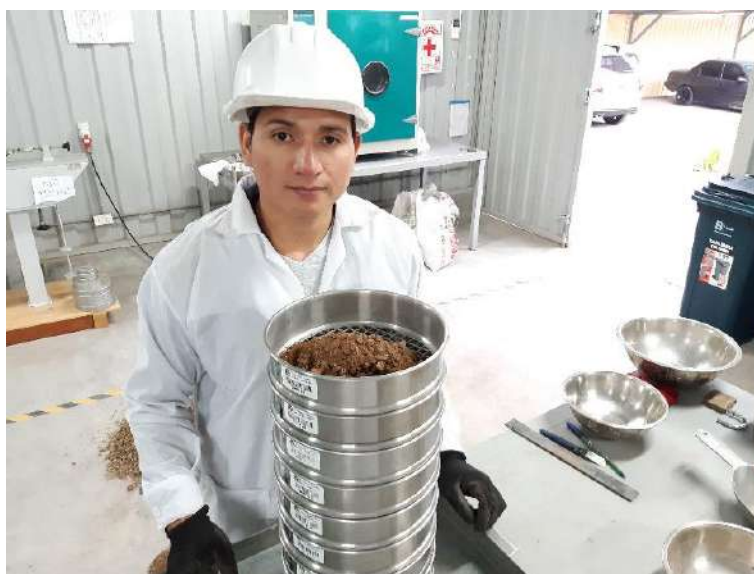
Figura 11. Tamizado de la mezcla de material para el análisis granulométrico
