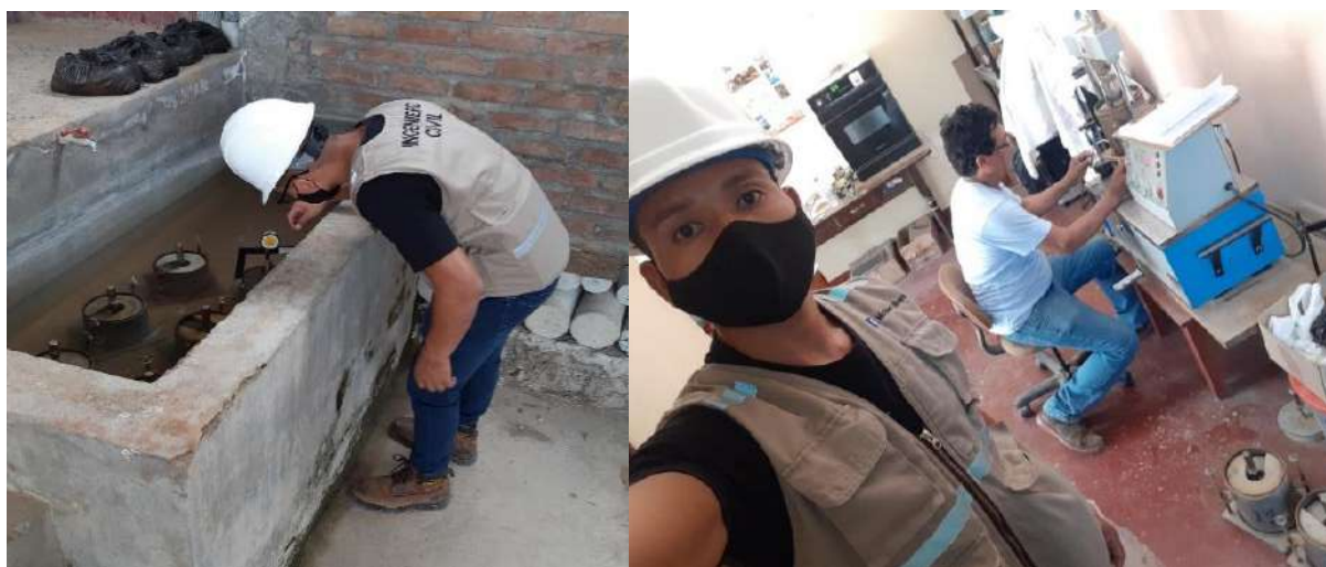
Figura 48. Ensayo cbr 60% afirmado y 40% ladrillo pulverizado.
