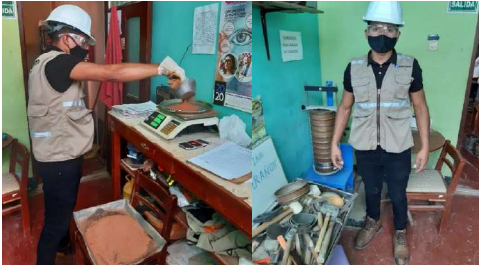
Figura 39. Ensayo granulometría (ladrillo pulverizado).
