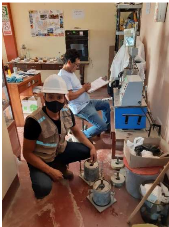
Figura 50. Ensayo cbr 60% afirmado y 40% ladrillo pulverizado.
