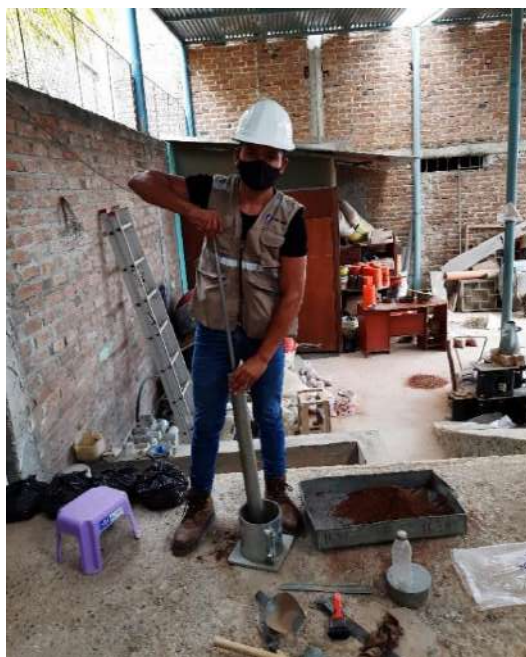
Figura 49. Ensayo proctor modificado 60% afirmado y 40% ladrillo pulverizado.
