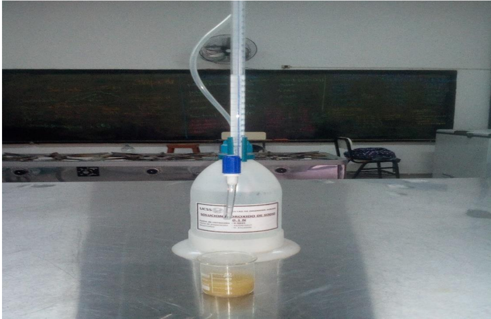
Medida del gasto de hidróxido de sodio.
