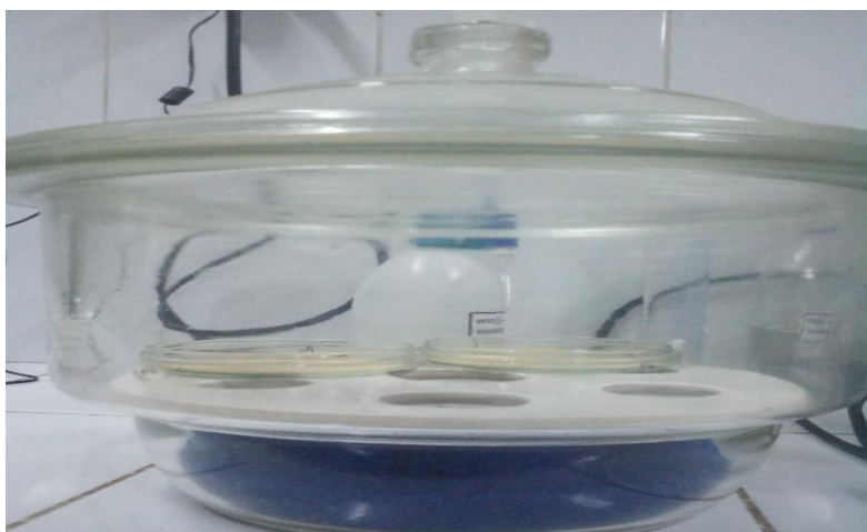
Enfriamiento de las muestras en el desecador de sílica de gel.
