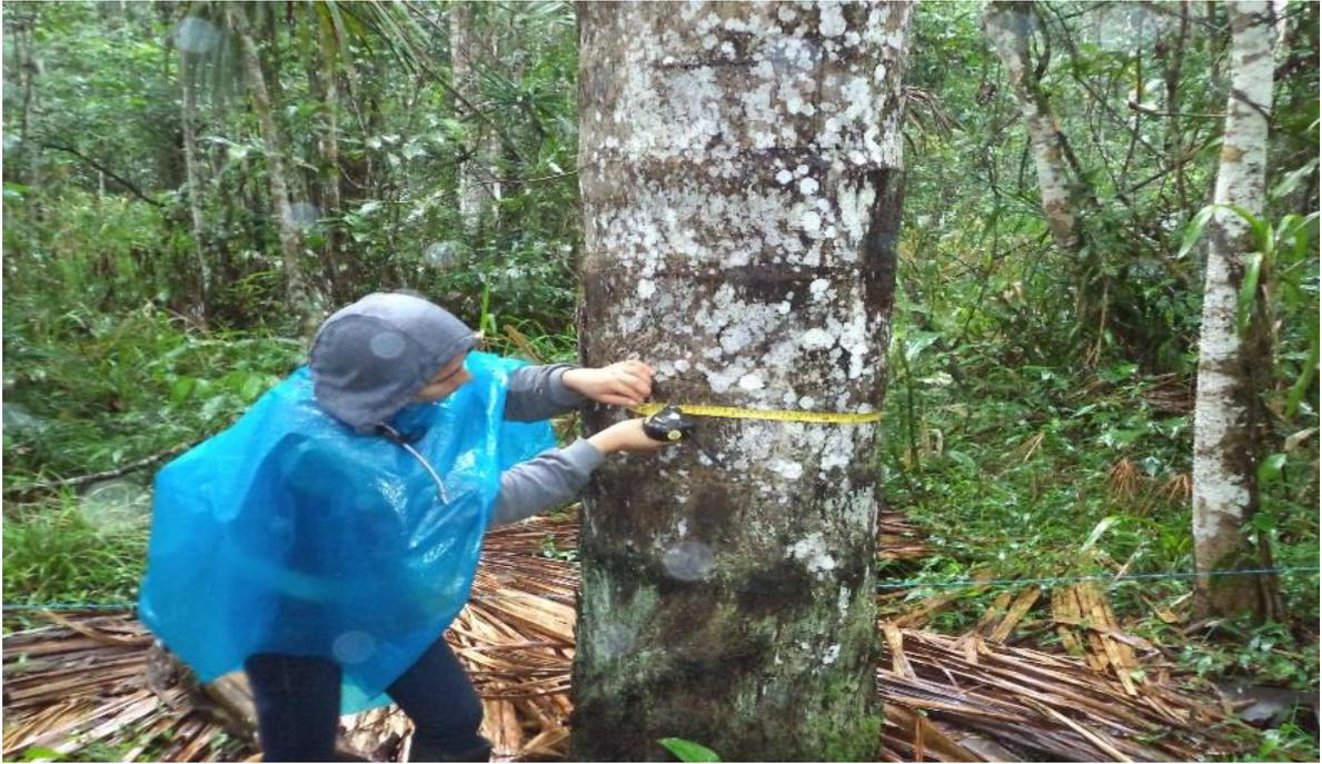
Fotografía 5: Medición biometría de diámetro a la altura del pecho (DAP)
