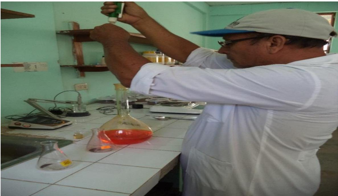
Fotografía 8: Dosificación de reactivo para la determinación del contenido de materia orgánica
