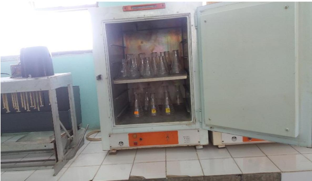
Fotografía 10: Estufa utilizada en la determinación de la humedad de las muestras (suelo y material vegetal)
