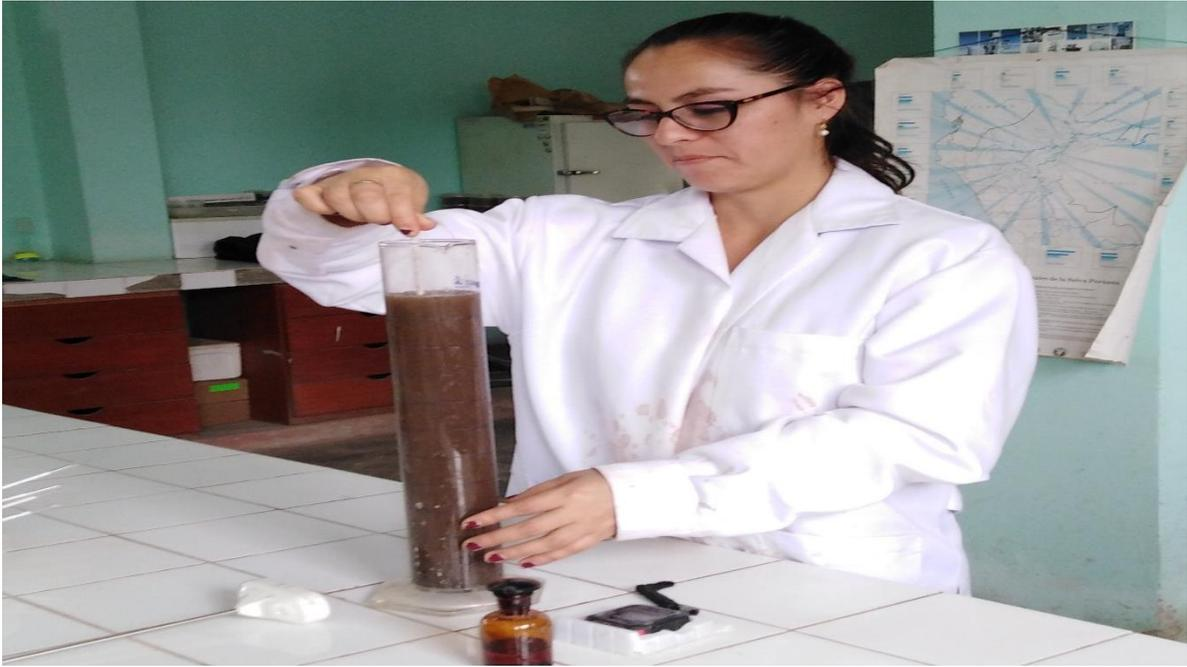
Fotografía 9: Determinación de la textura de suelo por el método de Bouyoucos
