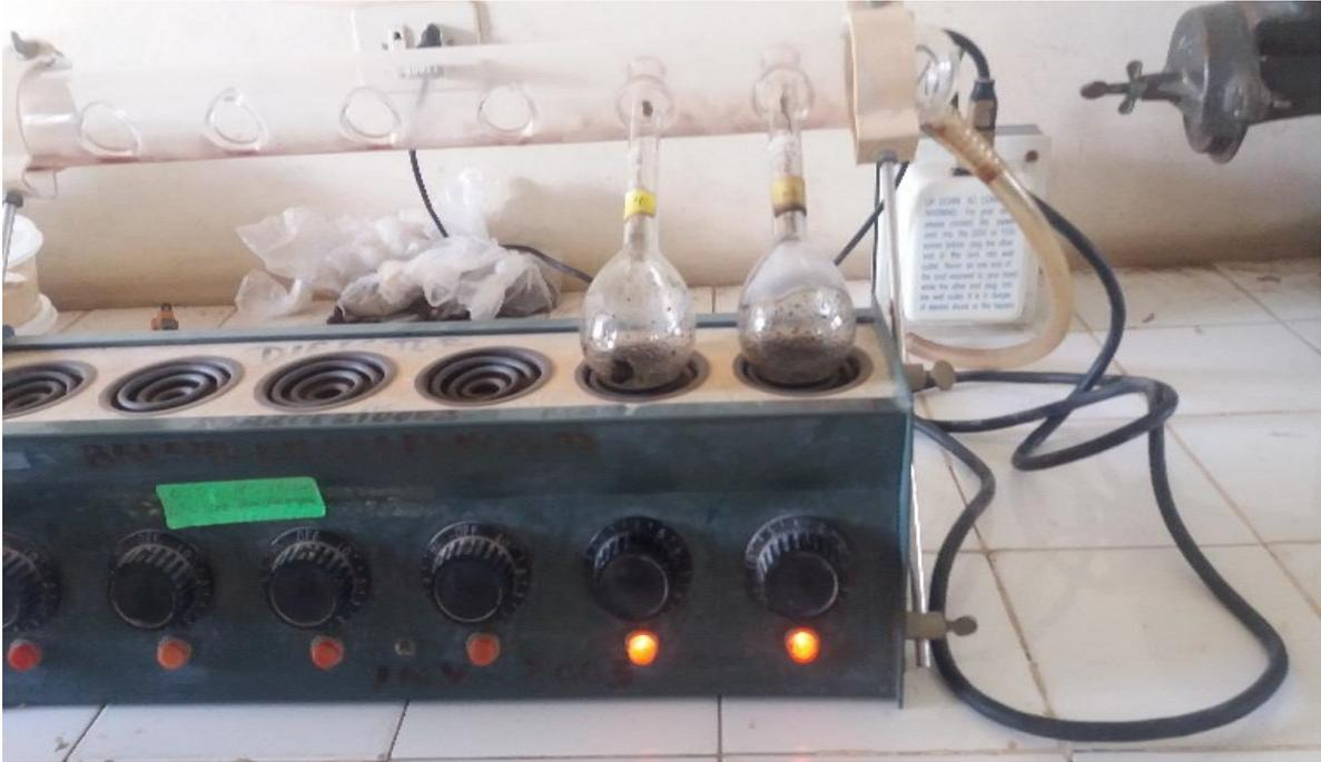
Figura 11: Digestor micro Kjeldahl para la determinación de nitrógeno total
