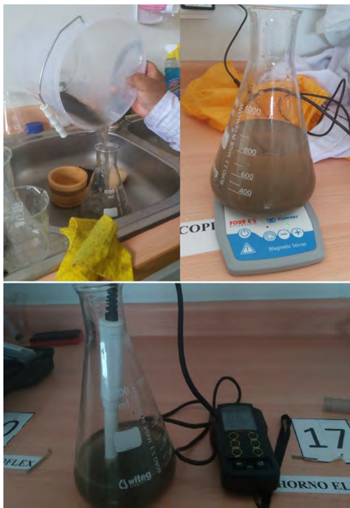
Figura 6. Extracción del elutriado del sedimento y su caracterización físico química.
