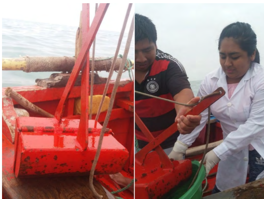
Figura 3. Draga Van Veen usada en la extracción de sedimentos marinos.
