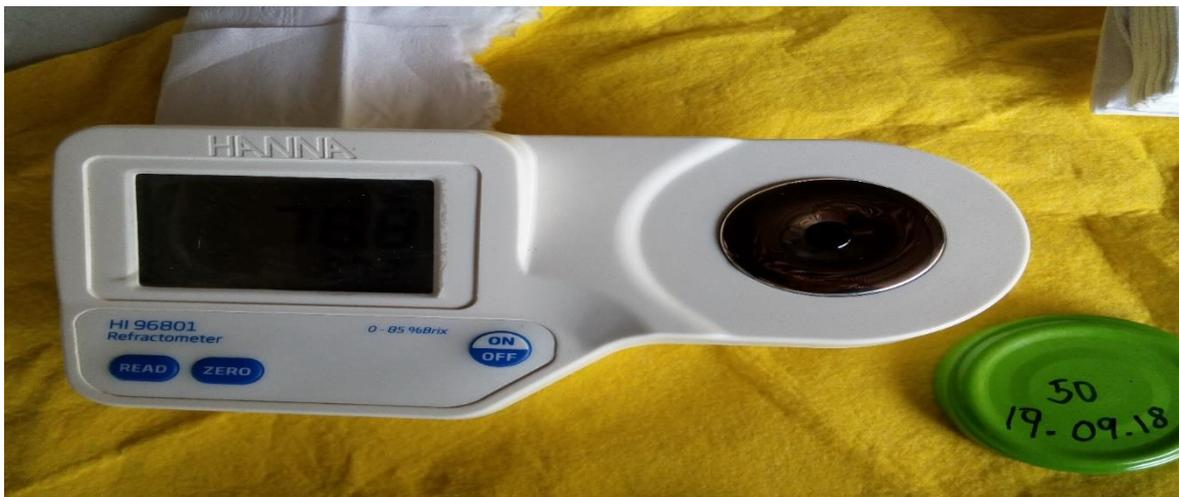
Medición °Brix. Brixómetro digital de ECOBOSQUE.
