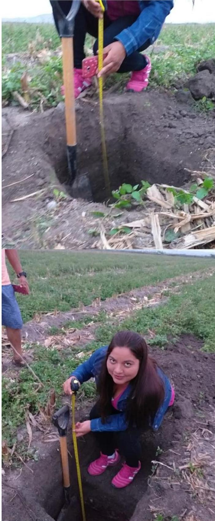
*Figura 21.* Realización de las calicatas para la toma de muestra de suelo en la localidad de Ruquia – Huaura. *Fuente:* Elaboración propia.
