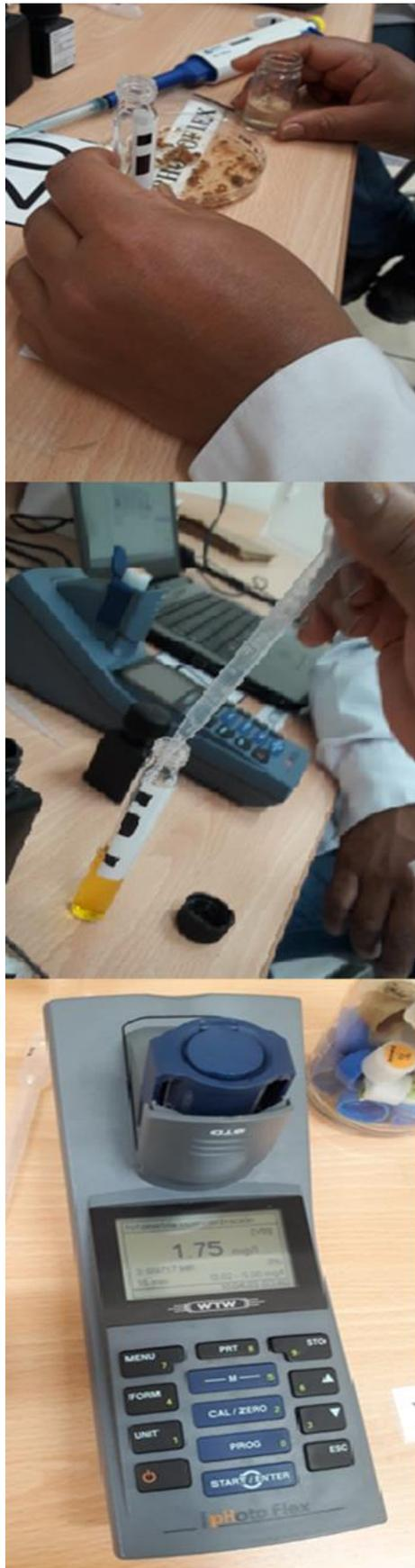
Figura 24. Preparación y lectura de las muestras con el fotómetro. Fuente: Elaboración propia.
