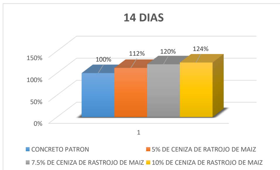
Figura 26. Resistencia a la compresión a los 14 días en comparación al concreto patrón
