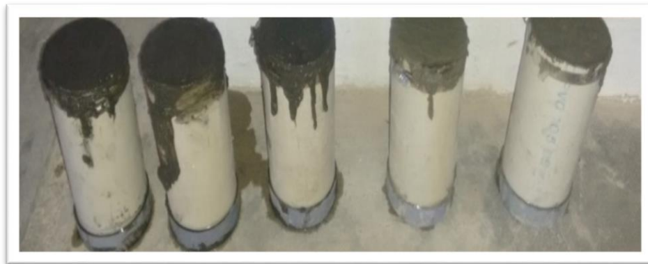
Figura 05. Muestras cilíndricas de concreto para ensayos de compresión
