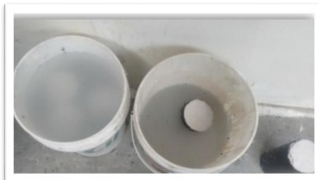
Figura 20. Curado del concreto
