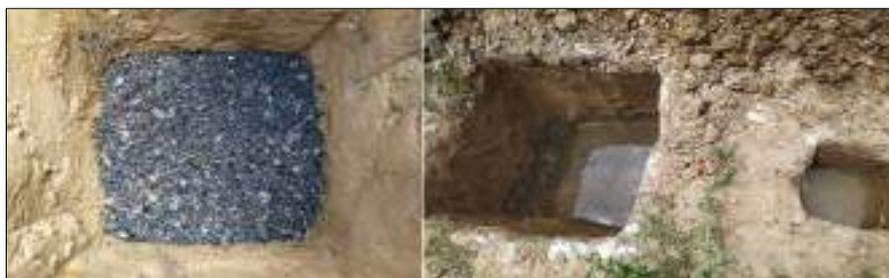
*Figura 6* Preparación y saturación del pozo de prueba
