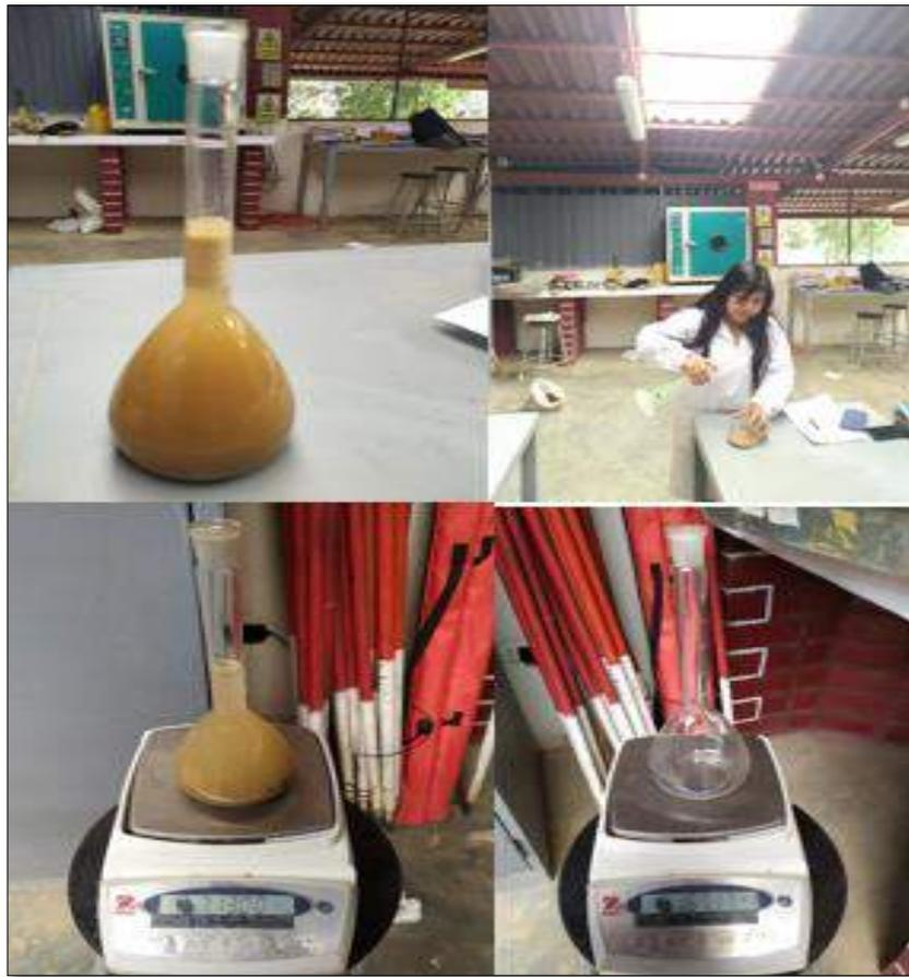
*Figura 43* Ensayo para la obtención del peso específico
