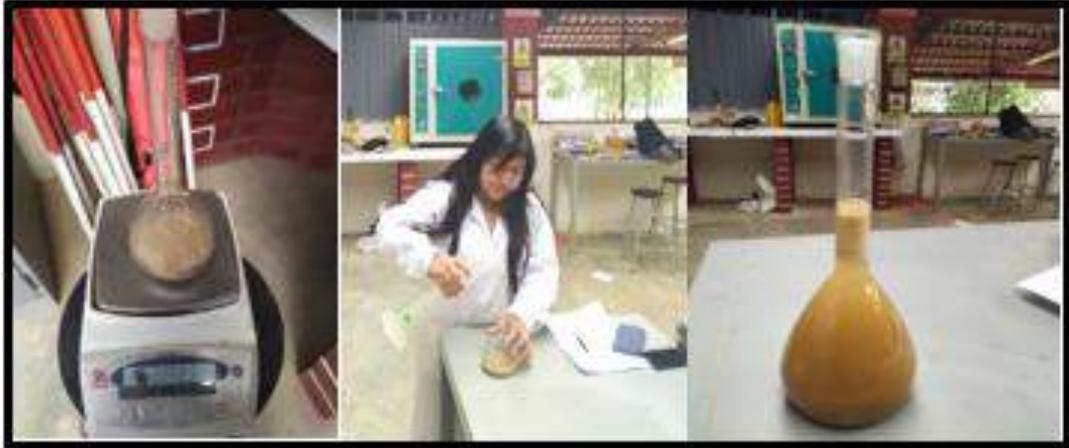
*Figura 11.* Ensayo para la obtención de peso específico y absorción
