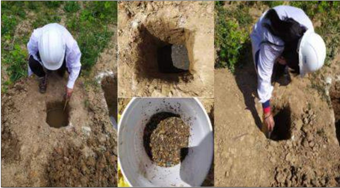
*Figura 39. Preparación y medición de los pozos para ensayo de infiltración y permeabilidad*
