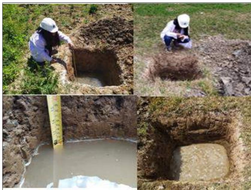
*Figura 9.* Medición de la variación del nivel freático
