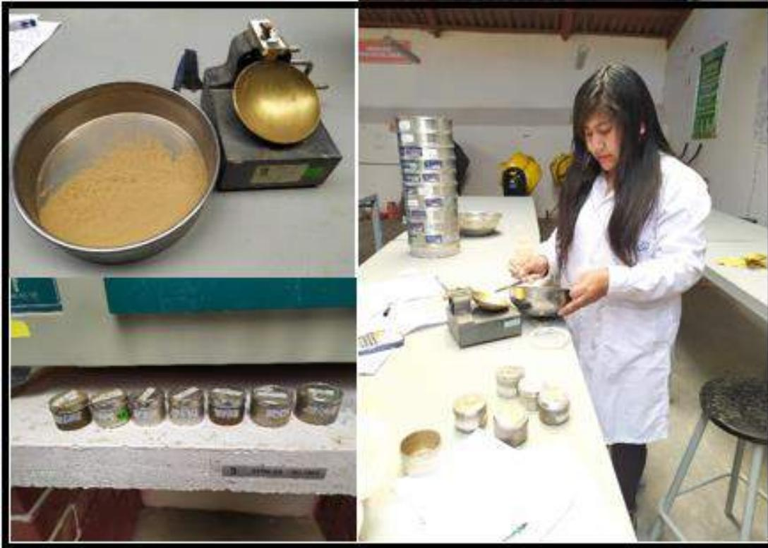
Figura 13. Ensayo para determinar los límites de Atterberg
