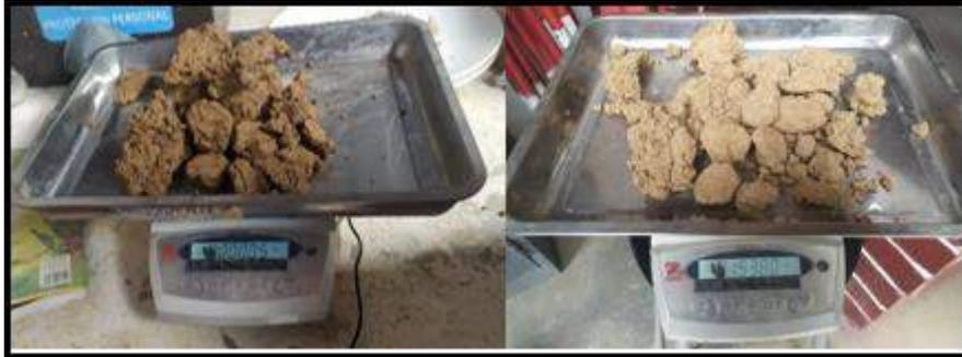
*Figura 12.* Ensayo de contenido de humedad
