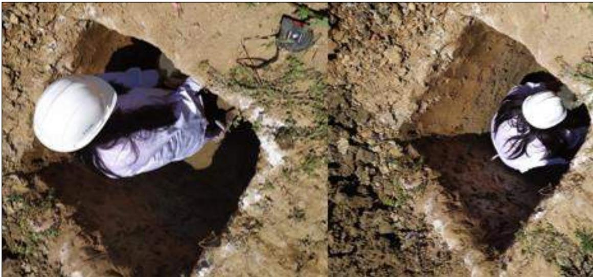
*Figura 40. Obtención de la muestra de suelo*
