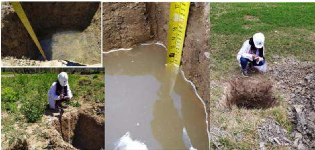
*Figura 38.* Medición de la variación del nivel freático.
