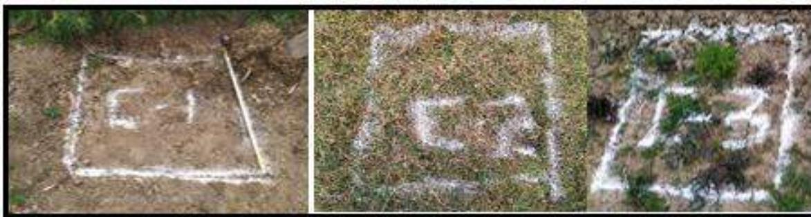
*Figura 8.* Selección de calicatas para la medición del nivel freático
