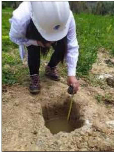
*Figura 7. La tesista monitoreando la tasa de infiltración*
