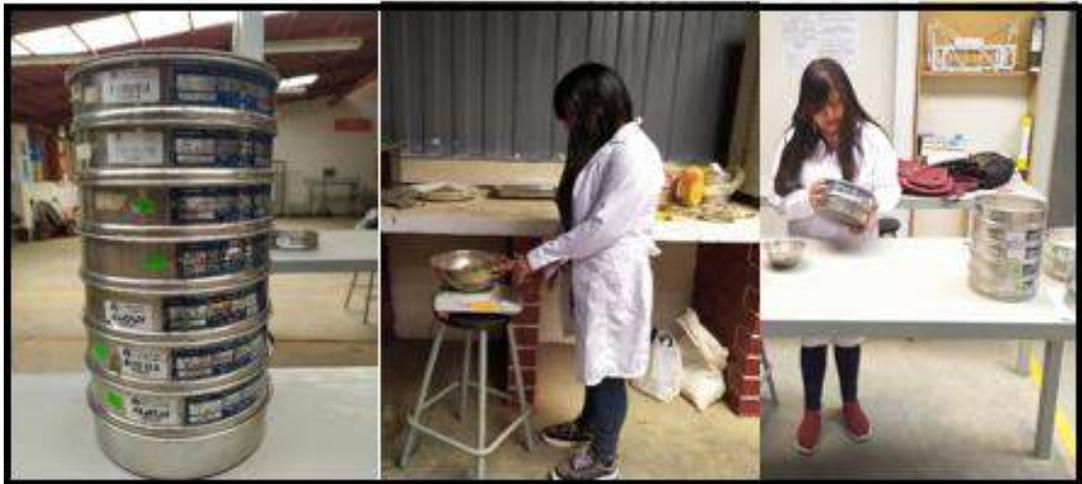
*Figura 10. Ensayo granulométrico*
