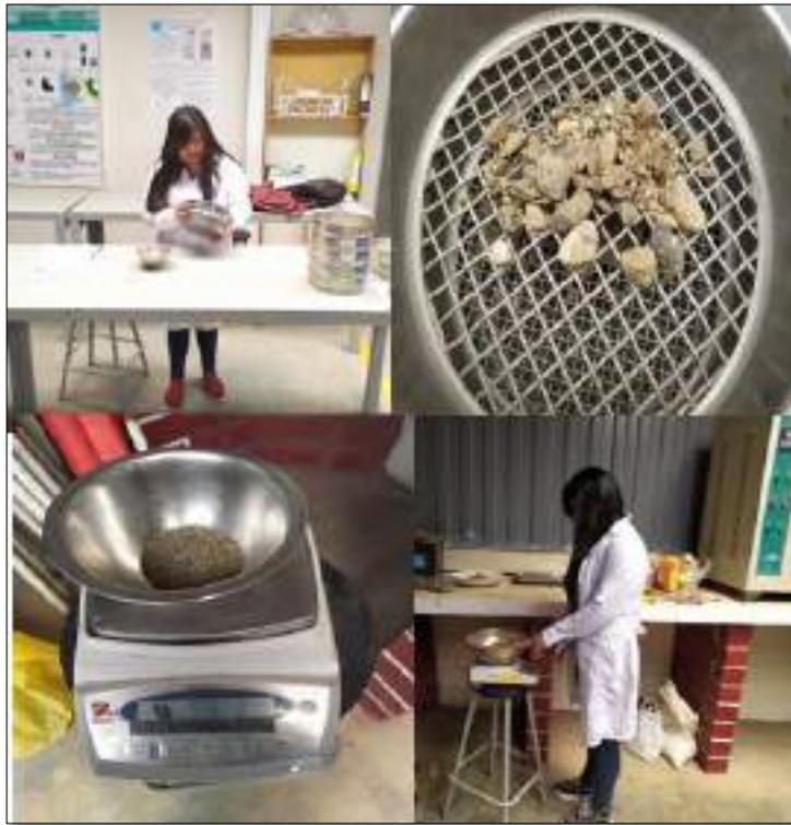
*Figura 41. Análisis granulométrico*
