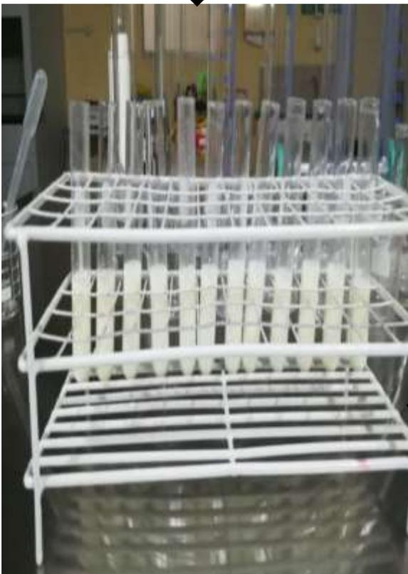
*Figura 23.* Determinación de la resistencia a la prueba de alcohol de la leche cruda.
