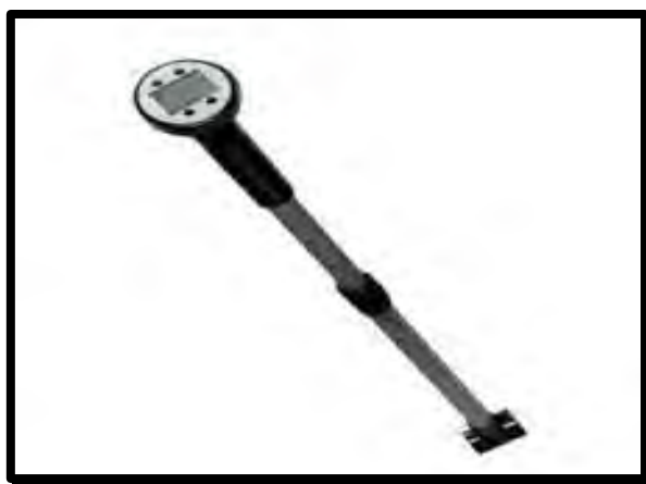
Figura 4. Correntómetro Global Water modelo FP11. Fuente: Tech Perú Industrial S.A.C, 2018.
