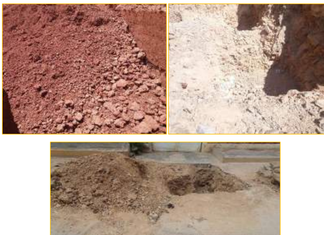
Figura 9. (a) suelo del barrio San Bartolomé, (b) calicata en el barrio San Cristóbal y (c) calicata en el barrio Peña Dorada.
