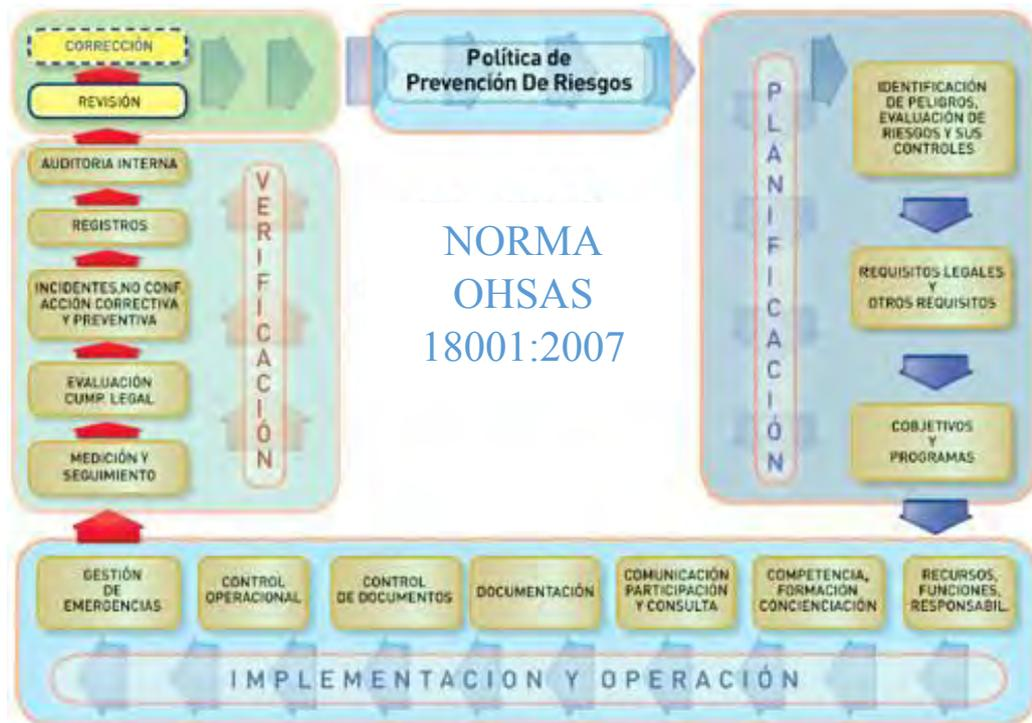
**Figura 19. Esquema de la Norma OHSAS 18001:2007**
