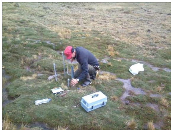
Figura 20. Toma de muestras de agua en pozo de monitoreo.
