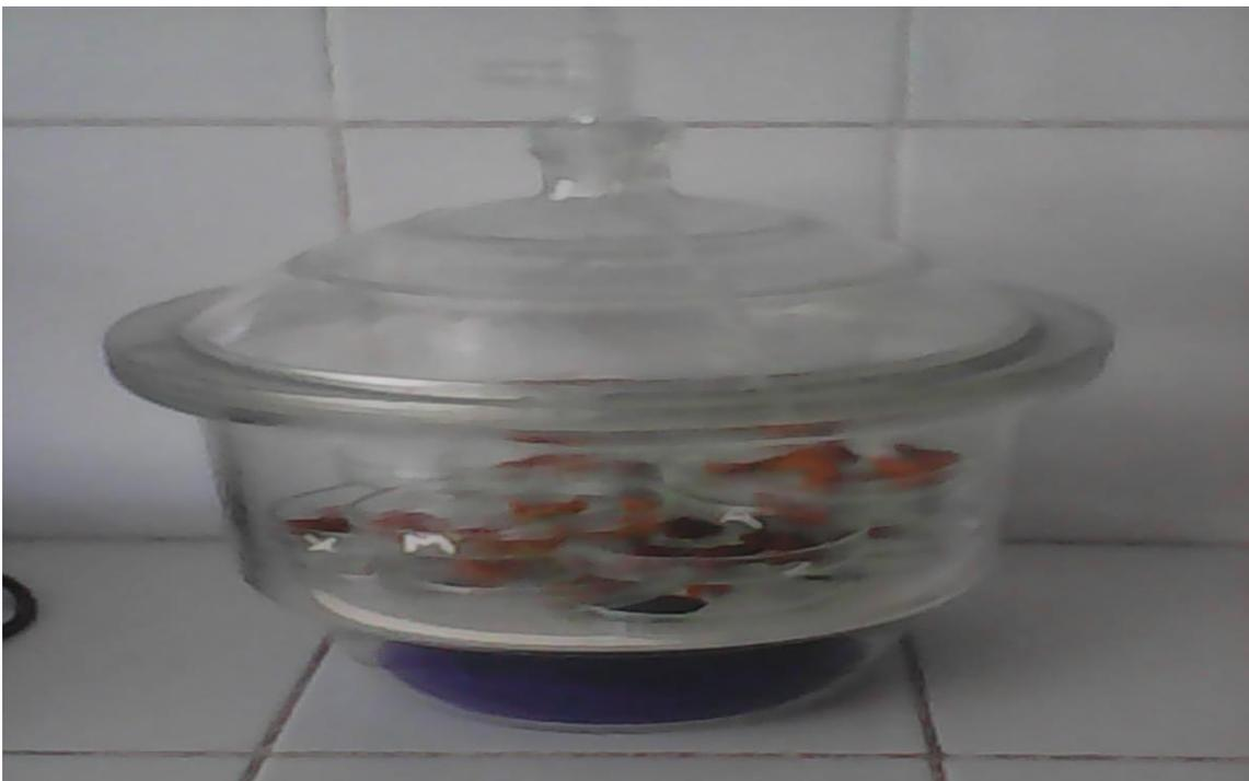
*Figura 31.* Mango deshidratado molido y almacenado en el desecador con sílica de gel.
