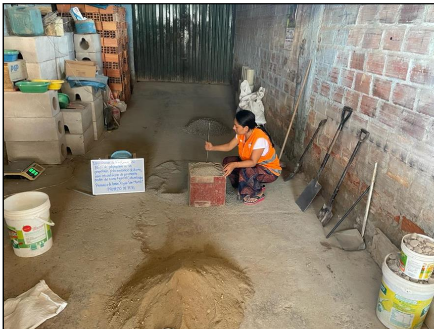
Fotografía N°06: Ensayo para determinar el peso unitario varillado.
