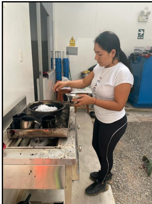
Fotografía N°24: Incorporación de las fibras de polipropileno en PEN 60/70.
