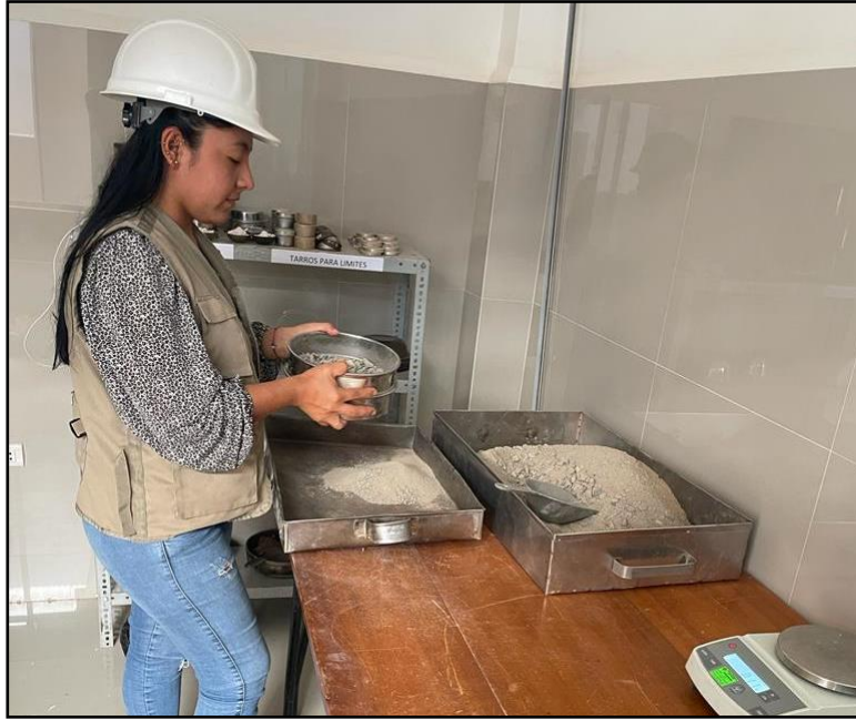
Fotografía N°19: Tamizado del material granular mezclado.
