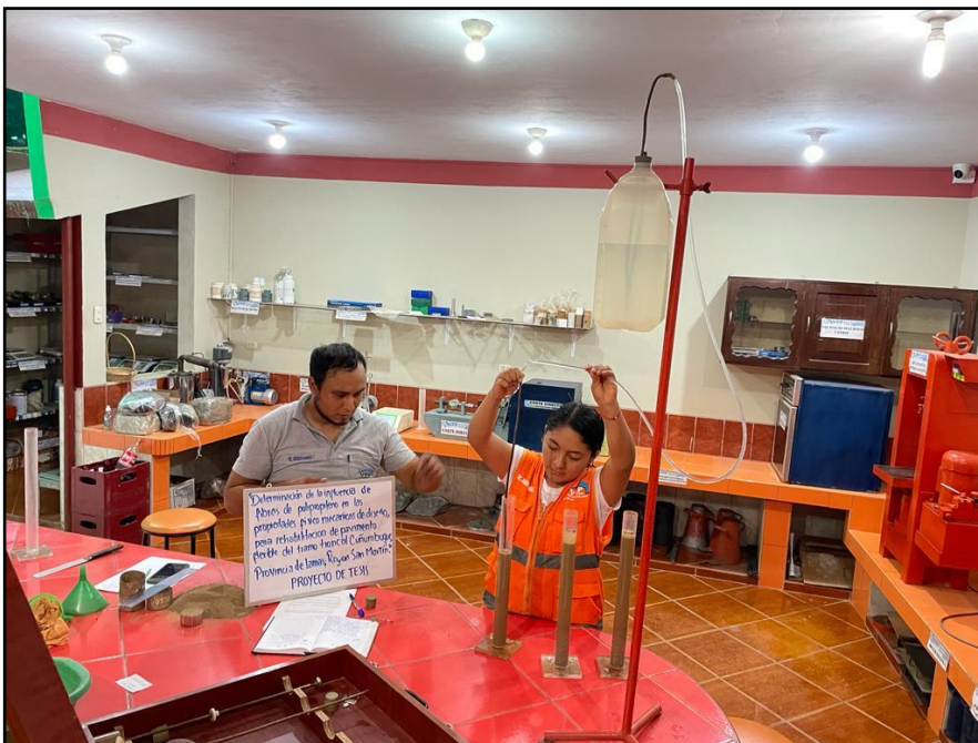
Fotografía N°09 y 10: Ensayo de equivalente de arena.
