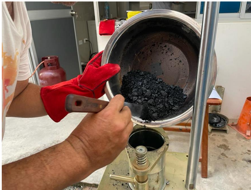
Fotografía N°26: Colocación de la mezcla asfáltica en el pedestal.
