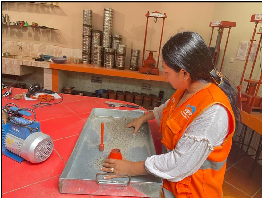
Fotografía N°12: El material granular se hace la prueba con el molde cónico para observar si se encuentra superficialmente seco.
