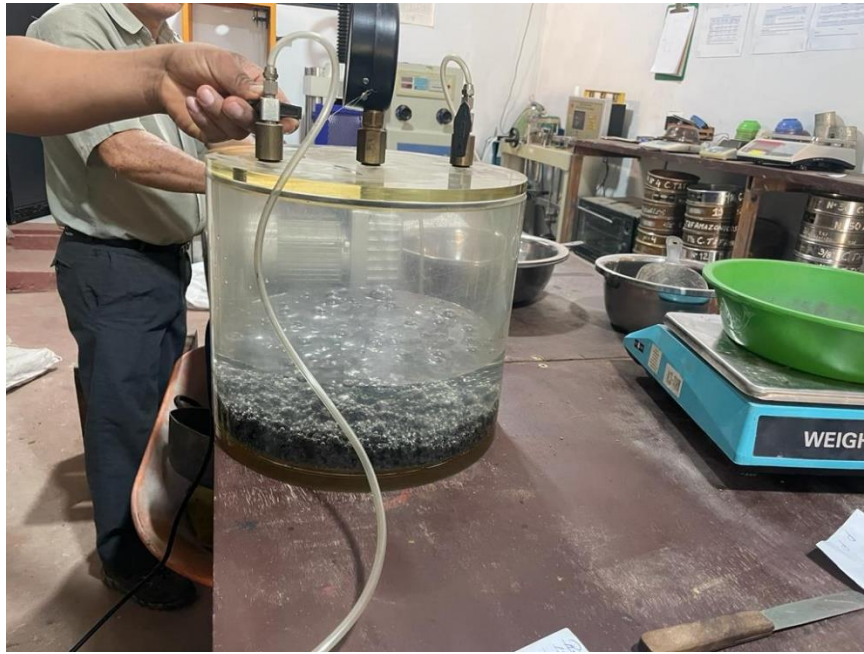
Fotografía N°29: Bomba de vacíos.
