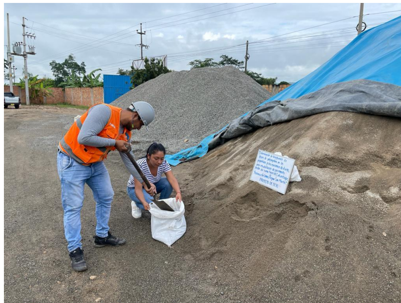
Fotografía N°04: Recolección del material granular (agregado fino) de la planta de asfalta de ubicada en Tarapoto.
