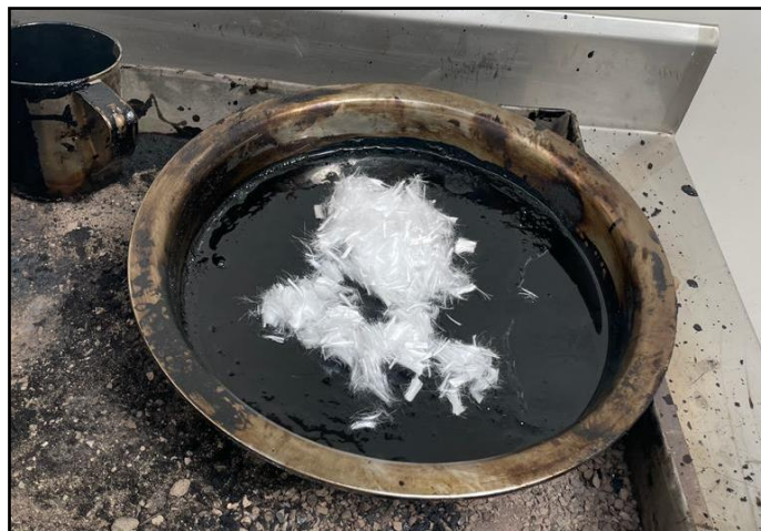
Incorporación de PP en la mezcla asfáltica
