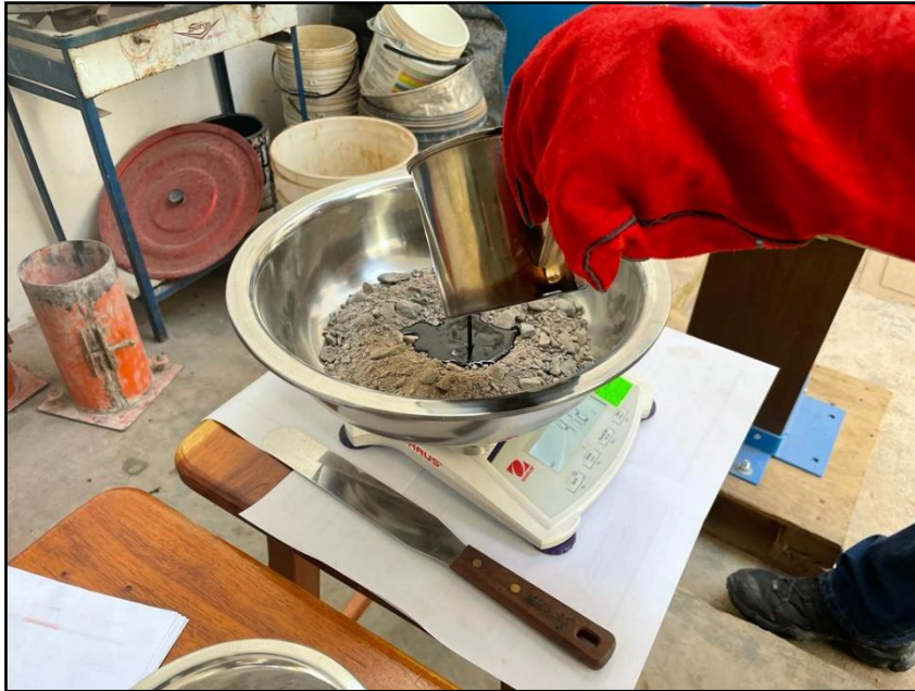
Fotografía N°21: Incorporación de la mezcla asfáltica convencional en los agregados.
