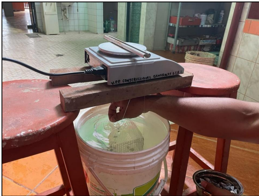
Fotografía N°15: Método de la canastilla para determinar el porcentaje de absorción.
