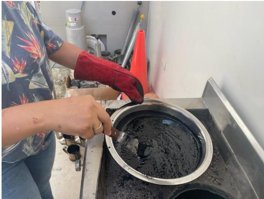
Fotografía N°25: Mezcla asfáltica con adición de fibras de polipropileno.
