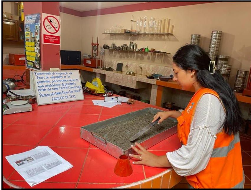
Fotografía N°11: Esparcimiento homogéneo de la arena triturada para el secado.
