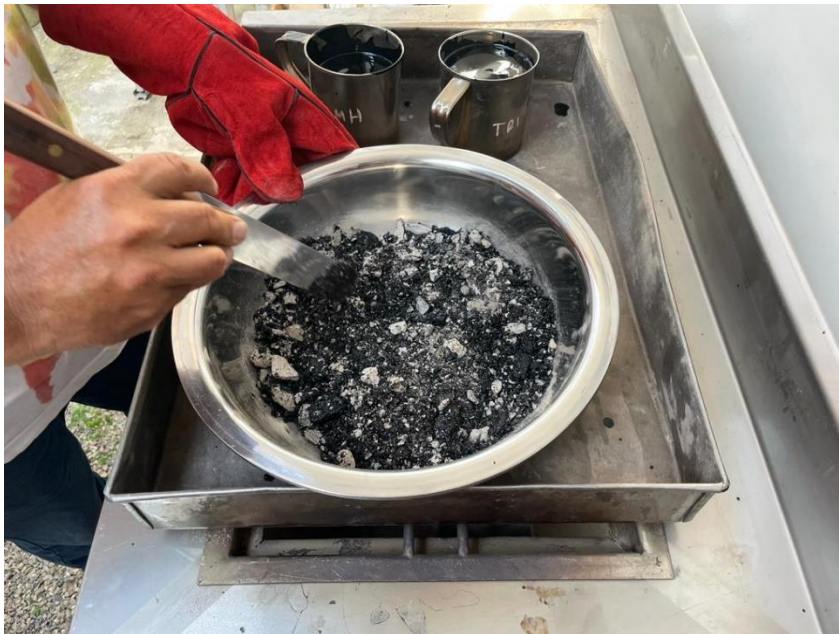
Fotografía N°22: Mezcla homogénea de los agregados y PEN 60/70.
