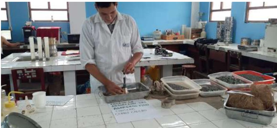
*Nota.* Los ensayos de absorción del agregado fino (arena) de la cantera Cerro Calero y centros de acopio Carranza y Nodaza Constructor, se realizaron en el laboratorio del Proyecto Especial Alto Mayo – PEAM, del distrito de Nueva Cajamarca. Para este ensayo se aplicó el método del cono.
