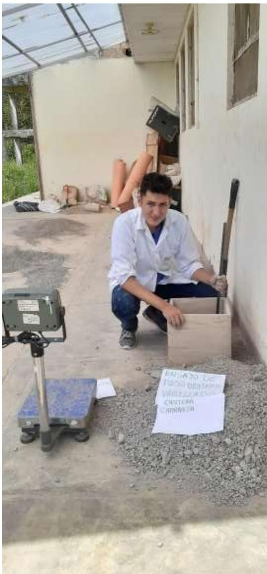
*Nota.* Los ensayos peso unitario suelto (PUS) y peso unitario varillado (PUV), del agregado fino (arena) y grueso (piedra chancada) de la cantera Cerro Calero y centros de acopio Carranza y Nodaza Constructor, se realizaron en el laboratorio del Proyecto Especial Alto Mayo – PEAM, del distrito de Nueva Cajamarca. Se aplicó cubos de madera con volumen de  $0,0283 \text{ m}^3$
