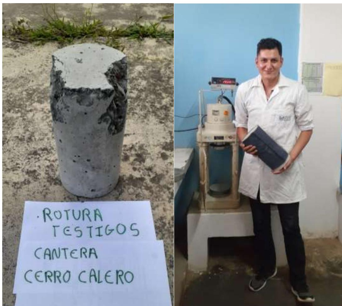
*Nota.* La cantidad de prototipos sometidos a esfuerzos de compresión fueron 10 por cantera y centro de acopio en periodos de 7, 14 y 28 días, la rotura se desarrolló en la prensa hidráulica del laboratorio del Proyecto Especial Alto Mayo – PEAM, del distrito de Nueva Cajamarca.
