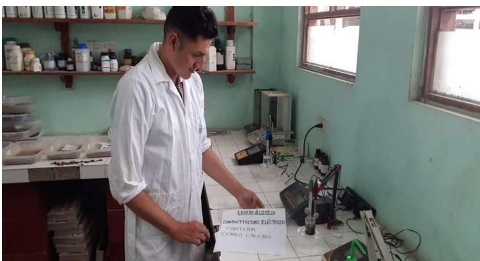
*Nota.* Los ensayos peso conductividad eléctrica y sales de los agregados finos (arena), de la cantera Cerro Calero y centros de acopio Carranza y Nodaza Constructor, se realizaron en el laboratorio del Proyecto Especial Alto Mayo – PEAM, del distrito de Nueva Cajamarca.
