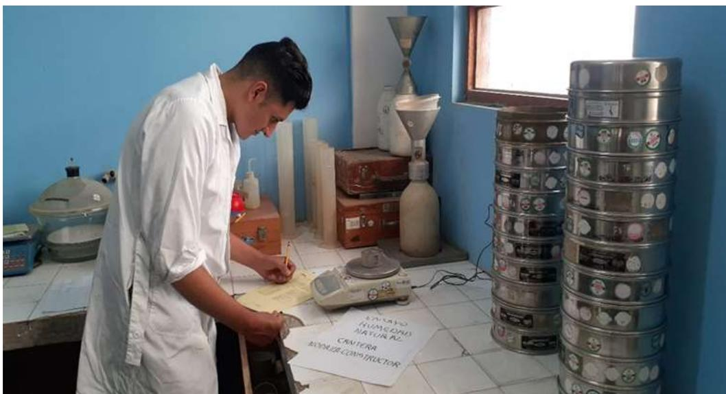
*Nota.* Los ensayos de humedad natural del agregado fino (arena) y grueso (piedra chancada) de la cantera Cerro Calero y centros de acopio Carranza y Nodaza Constructor, se realizaron en el laboratorio del Proyecto Especial Alto Mayo – PEAM, del distrito de Nueva Cajamarca.
