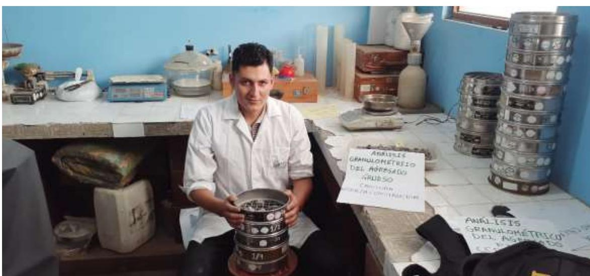
*Nota.* Los ensayos de granulometría se realizaron en el laboratorio del Proyecto Especial Alto Mayo – PEAM, del distrito de Nueva Cajamarca, los ensayos realizados fueron de agregado fino (arena) y grueso (piedra chancada) con muestra de 3000 gramos, de la cantera Cerro Calero y centros de acopio Carranza y Nodaza Constructor. Del centro de acopio Carranza del agregado fino con una muestra de 2250 gramos.
