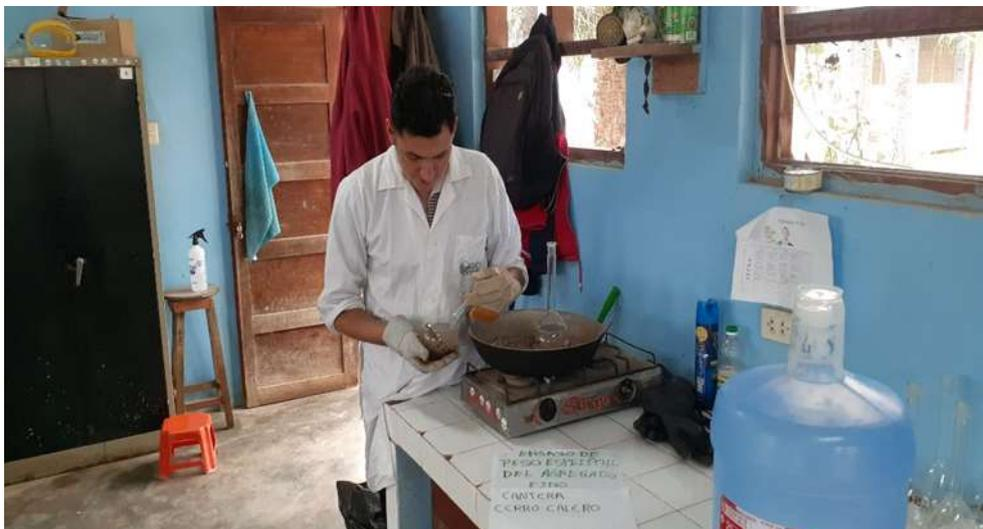
*Nota.* Los ensayos de peso específico del agregado fino (arena) de la cantera Cerro Calero y centros de acopio Carranza y Nodaza Constructor, se realizaron en el laboratorio del Proyecto Especial Alto Mayo – PEAM, del distrito de Nueva Cajamarca. Para este ensayo se aplicó el método de la fiola.
