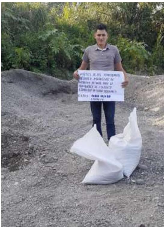
*Nota.* La recolección de muestras fue de agregados fino (arena) y agregado grueso (piedra chancada de 1/2”), del centro de acopio Carranza, se depositó en sacos plásticos, con una cantidad necesaria para realizar los ensayos de laboratorio y diseño de concreto hidráulico  $f'c = 210 \text{ kg/cm}^2$ .
