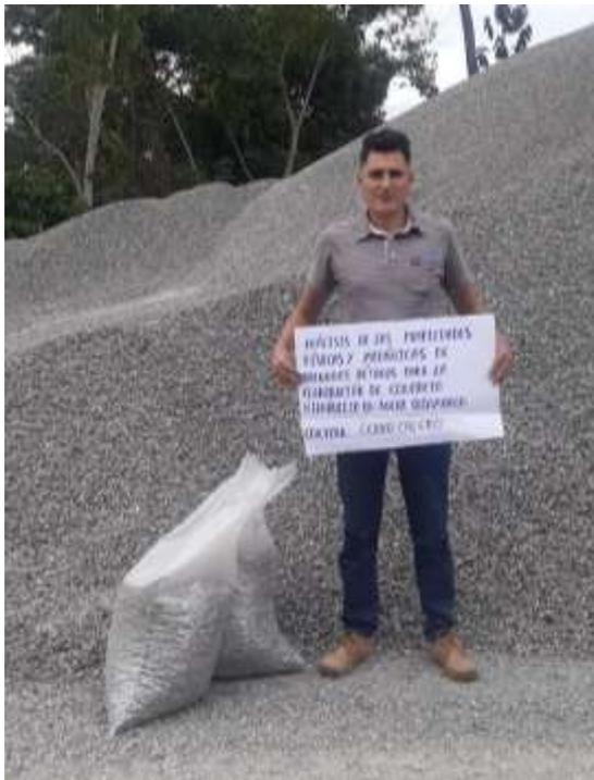
*Nota.* La recolección de muestras fue de agregados fino (arena) y agregado grueso (piedra chancada de 1/2”), de la cantera Cerro Calero, se depositó en sacos plásticos, con una cantidad necesaria para realizar los ensayos de laboratorio y diseño de concreto hidráulico  $f'c = 210 \text{ kg/cm}^2$
