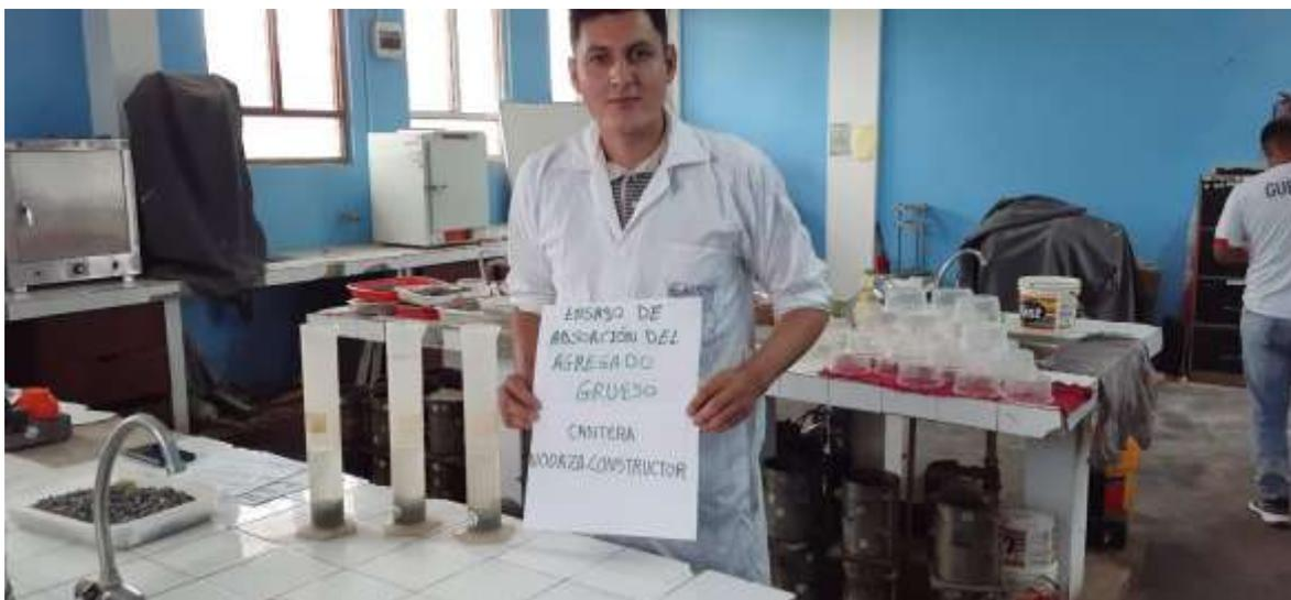
*Nota.* Los ensayos de absorción del agregado grueso (piedra chancada) de la cantera Cerro Calero y centros de acopio Carranza y Nodaza Constructor, se realizaron en el laboratorio del Proyecto Especial Alto Mayo – PEAM, del distrito de Nueva Cajamarca. Para este ensayo se aplicó el método de probetas.
