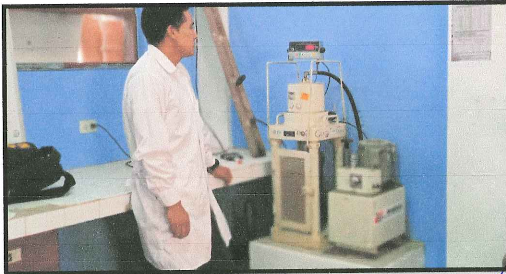
FOTO 8 Se observa al ejecutor del proyecto de investigación realizando las roturas de testigos de concreto según la NTP 339.034 y la ASTM C39
