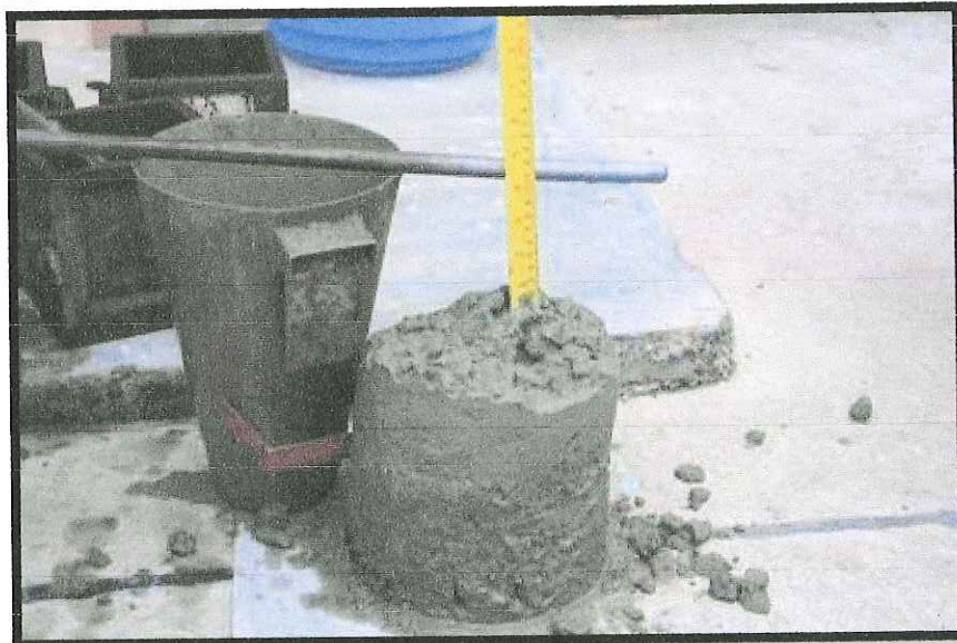
FOTO 03 Ensayo de Slump
