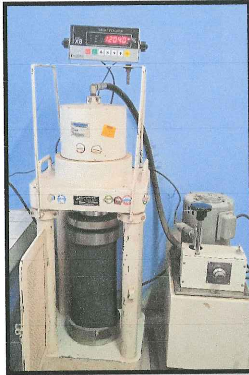
FOTO 8 Se observa al ejecutor del proyecto de investigación realizando las roturas de testigos de concreto según la NTP 339.034 y la ASTM C39
