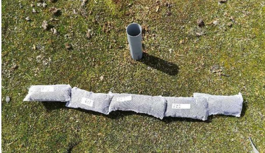
Figura 12. Instalación de muestras de turba en bolsas de malla nylon. Fuente: Elaboración propia.
