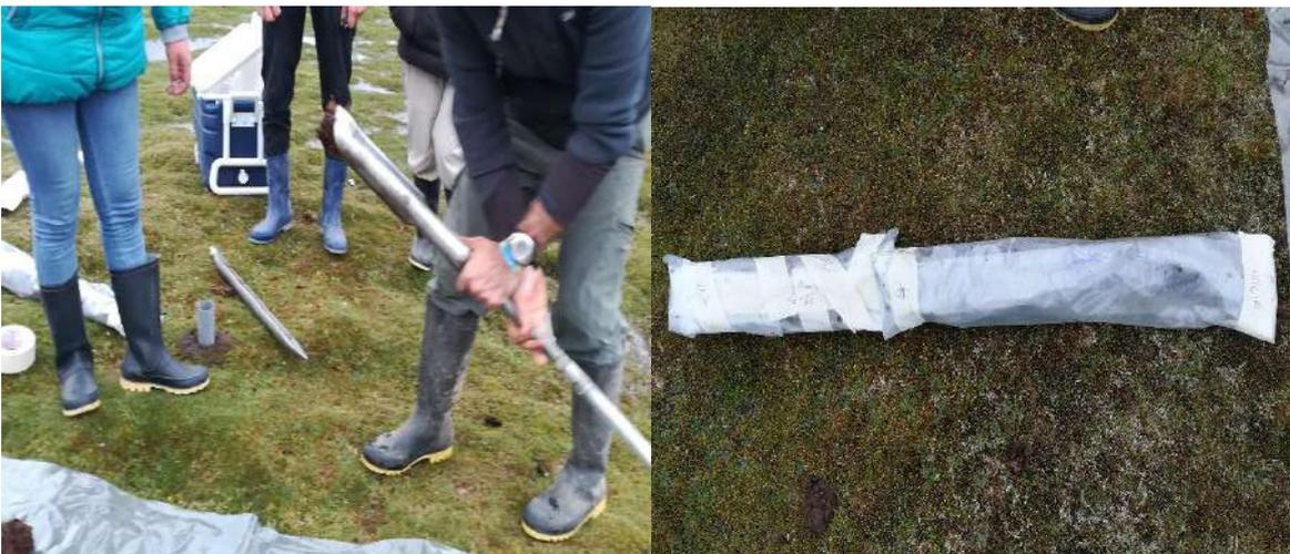
Figura 29. Extracción de muestra por box core. Fuente: Elaboración propia.
