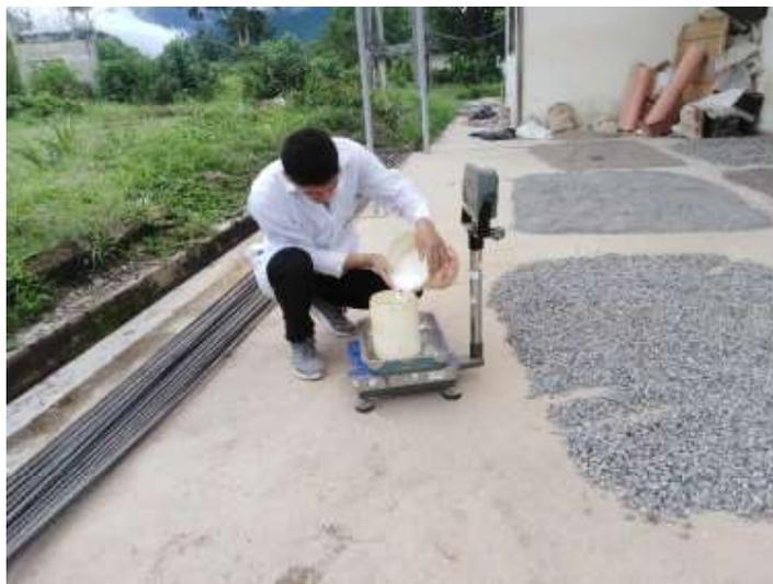
Figura 17. *Peso unitario suelto del poliestireno expandido.* Fuente: Elaboración propia (2021).
