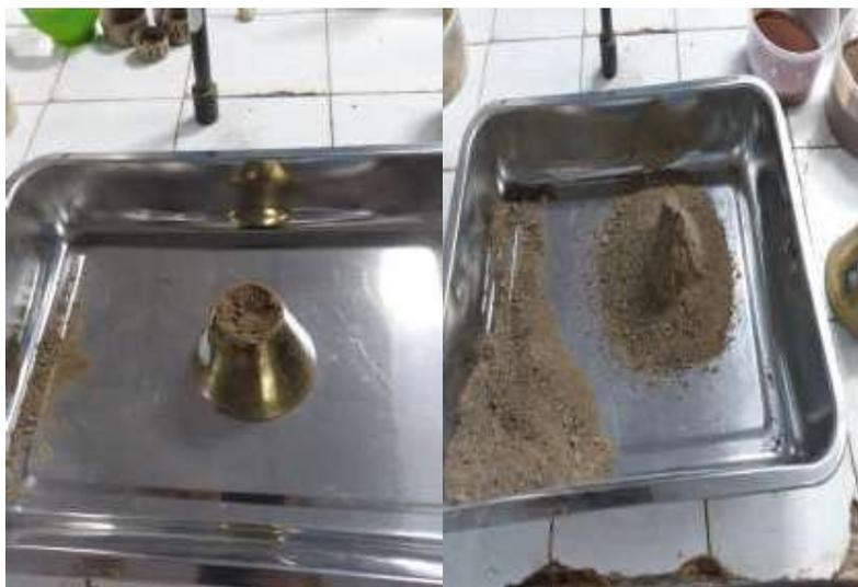
Figura 12. *Absorción del agregado fino.* Fuente: Elaboración propia (2021).
