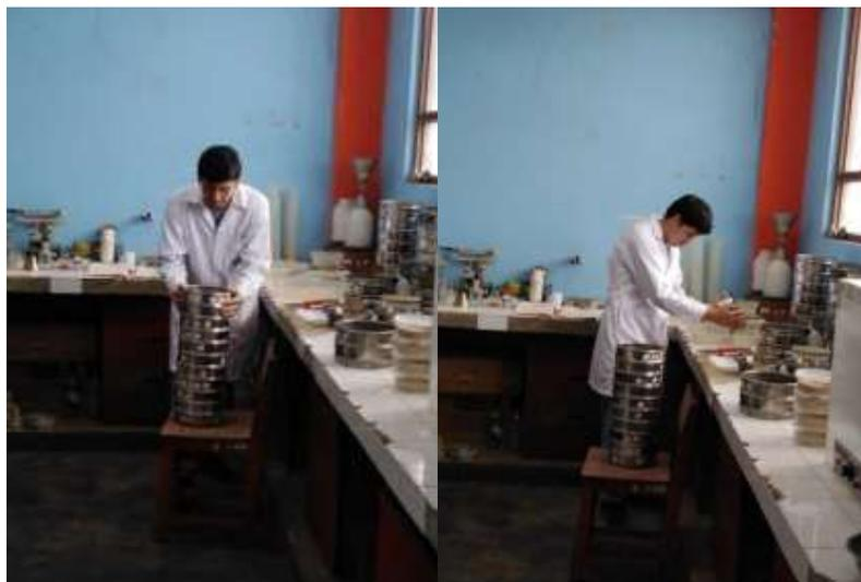
Figura 15. *Análisis granulométrico del agregado fino.* *Fuente:* Elaboración propia (2021).
