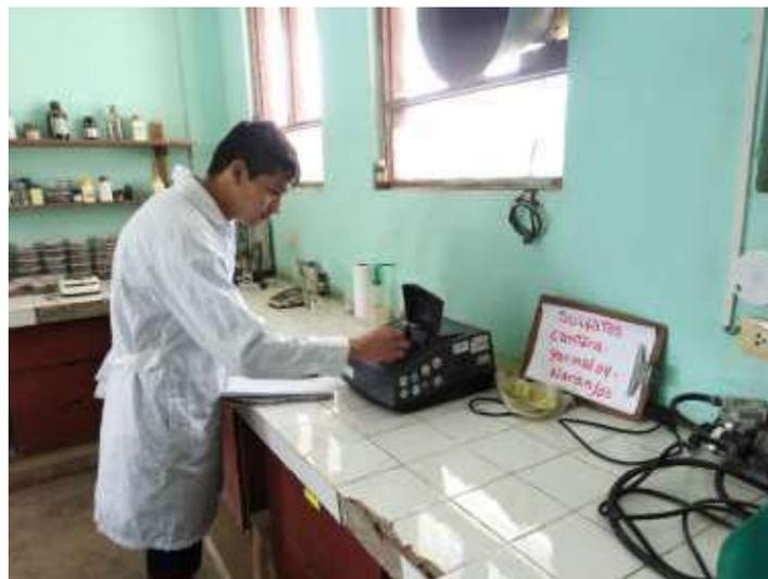
Figura 21. *Determinación de sulfatos del agregado fino.* *Fuente:* Elaboración propia (2021).
