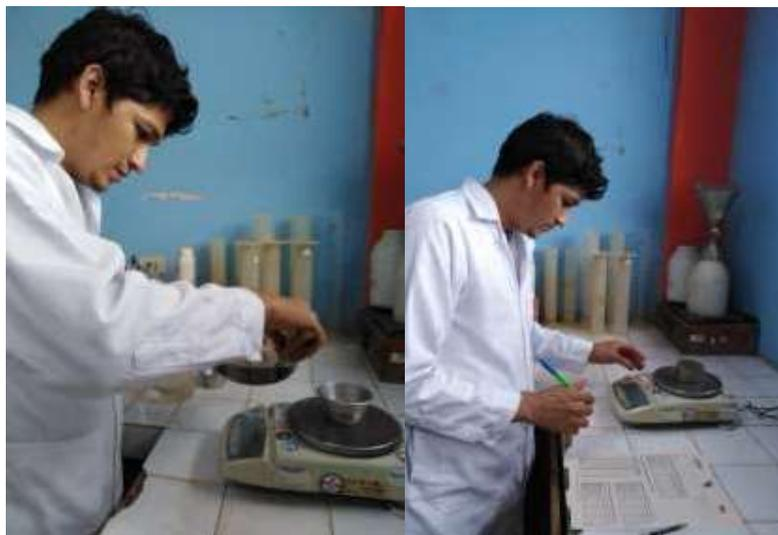
Figura 11. *Ensayo de humedad natural del agregado fino.* Fuente: Elaboración propia (2021).
