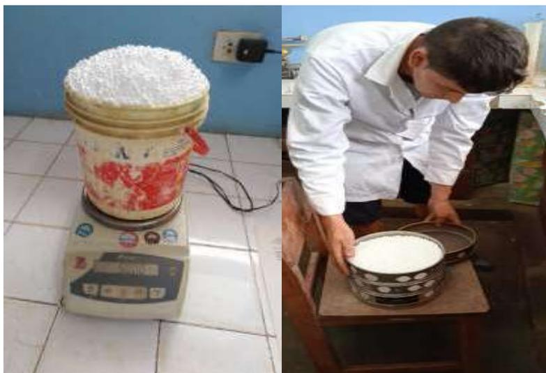
Figura 18. *Análisis granulométrico del poliestireno expandido.* Fuente: Elaboración propia (2021).
