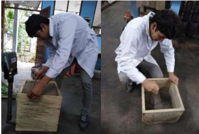
Figura 14. *Margen derecha peso unitario suelto e izquierda el peso unitario varillado.*
