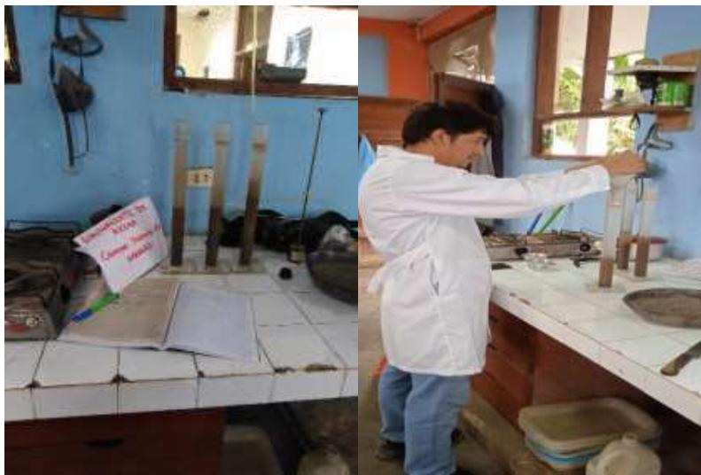
Figura 16. *Equivalente de arena*. Fuente: Elaboración propia (2021).
