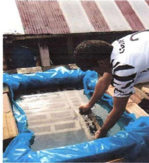
*Imagen 1: Tratamiento de los bloques por saturación*
