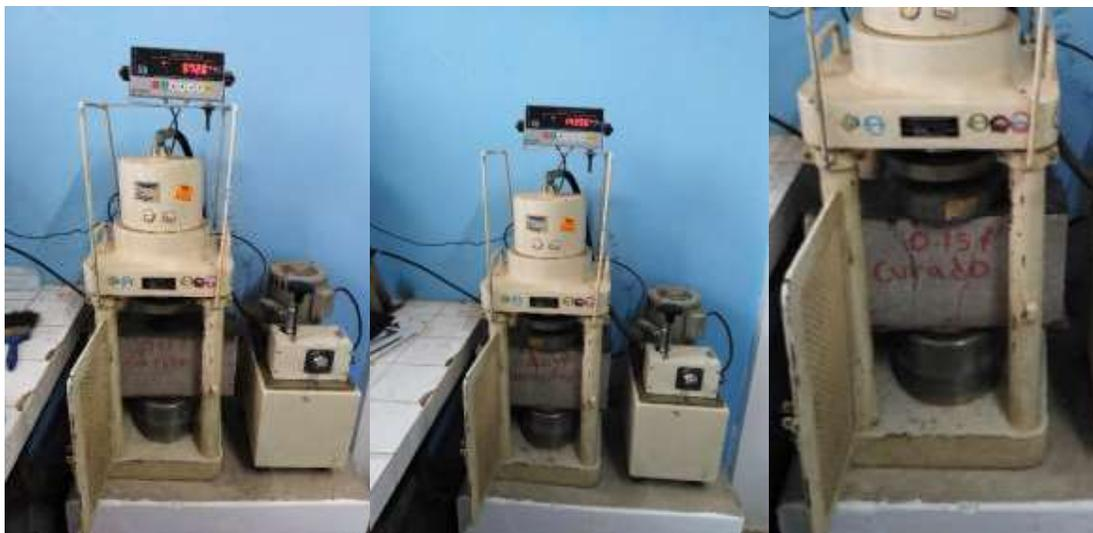
Figura 25. *Falla a compresión bloques de concreto sin curar, aspersion y saturación.*
