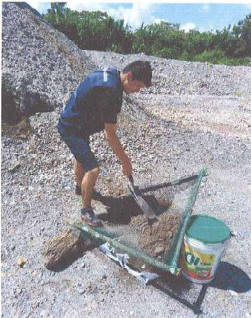
*Figura 3. Zarandeado dl agregado fino*
