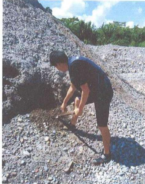
*Figura 2. Recolección muestreo del agregado fino*
