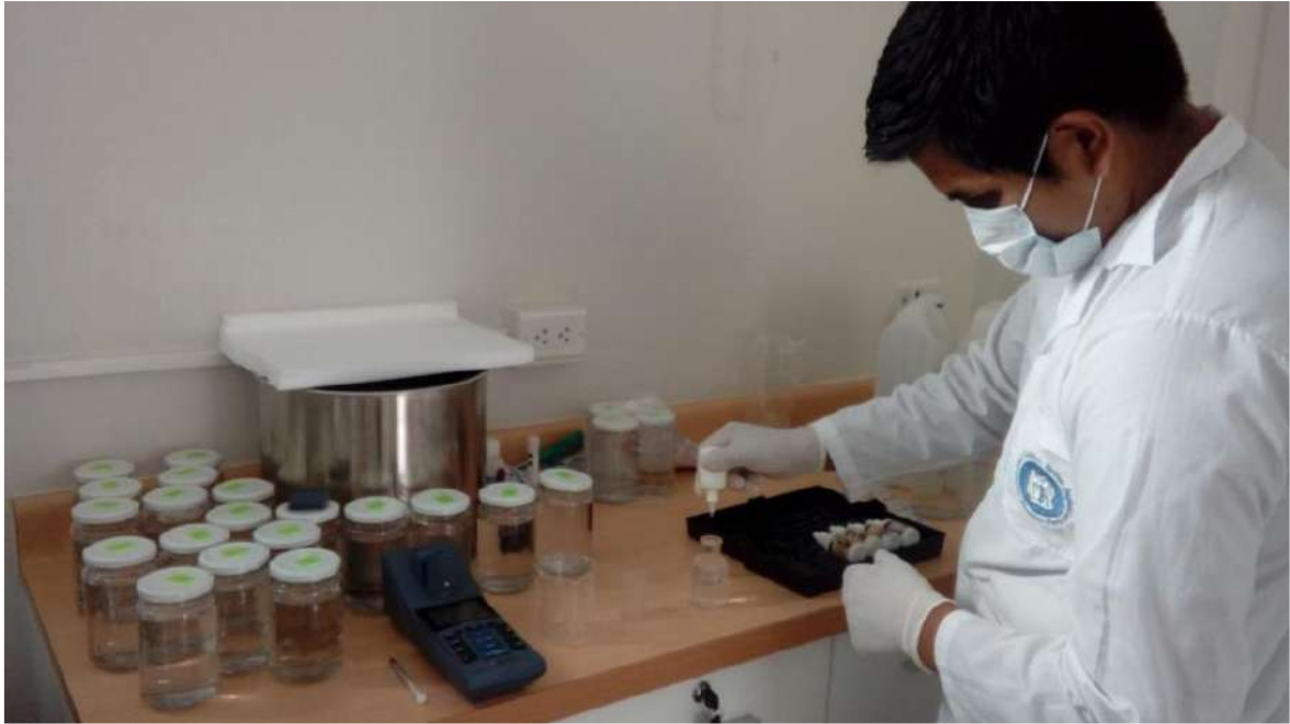
Figura 18. Cuantificación de concentración de arsénico. (1) Se está añadiendo 20 ml de ácidos sulfúrico al 97 %. Fuente: elaboración propia.
