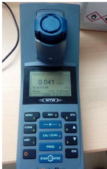
Figura 17. Primeros resultados de la determinación cuantitativa de Arsénico en las muestras de agua subterránea, con Espectrofotómetro photoFlex STD - WTW. Fuente: elaboración propia.
